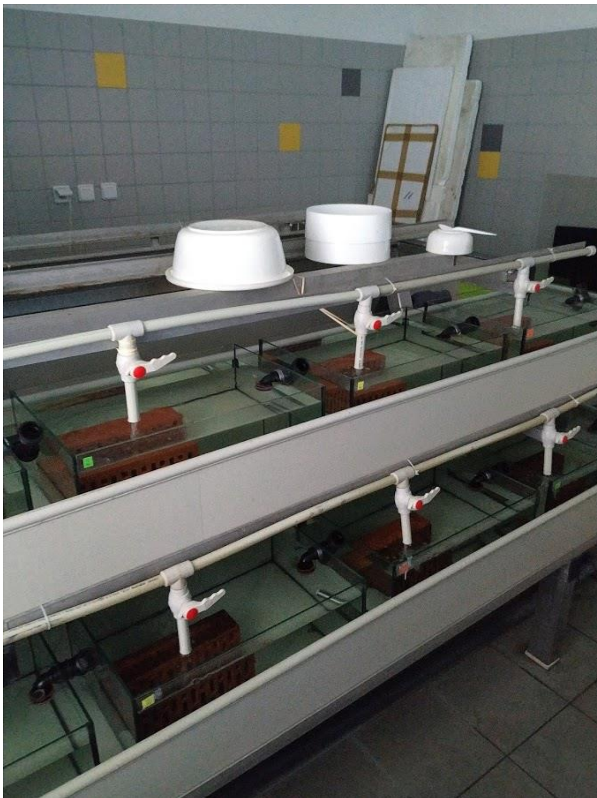
Obrázek 6: Recirkulační systém s odchovnými akvárii (foto autorka)
