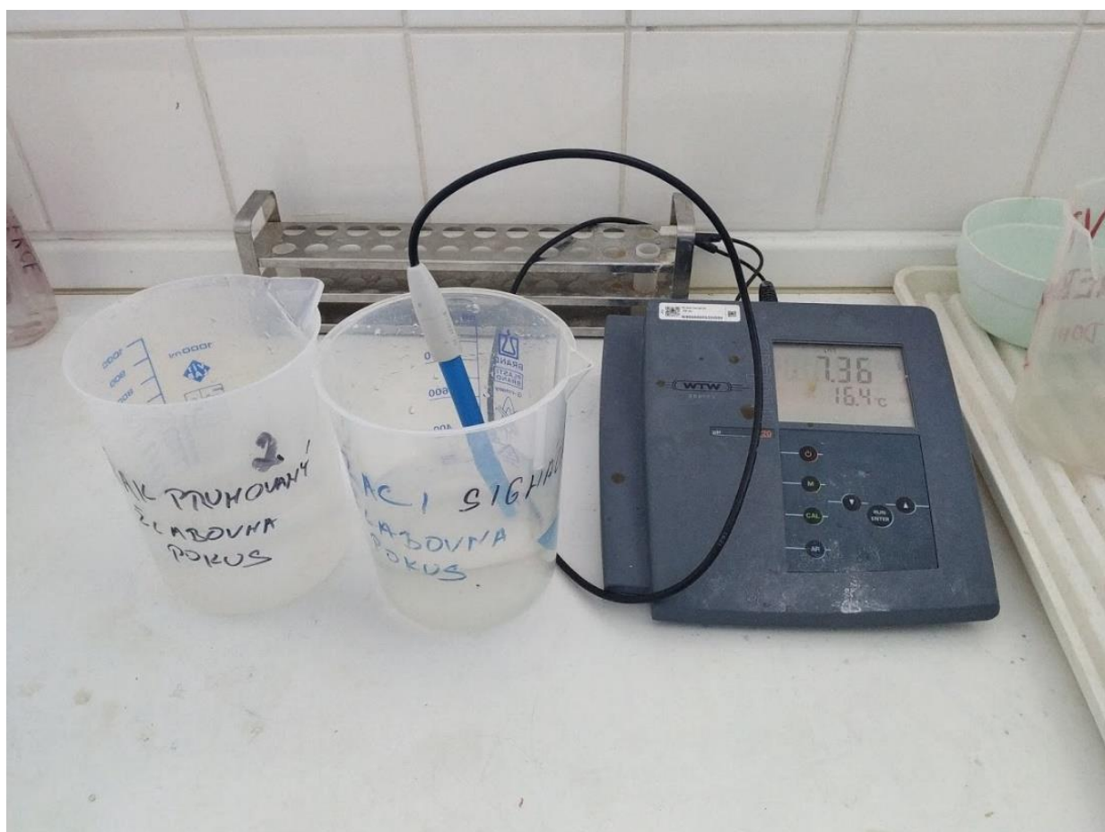
Obrázek 8: Monitorování pH vody pomocí laboratorního metru inoLab pH 7110 S2 (WTW GmbH, Weilheim, Německo), (foto: autorka)
