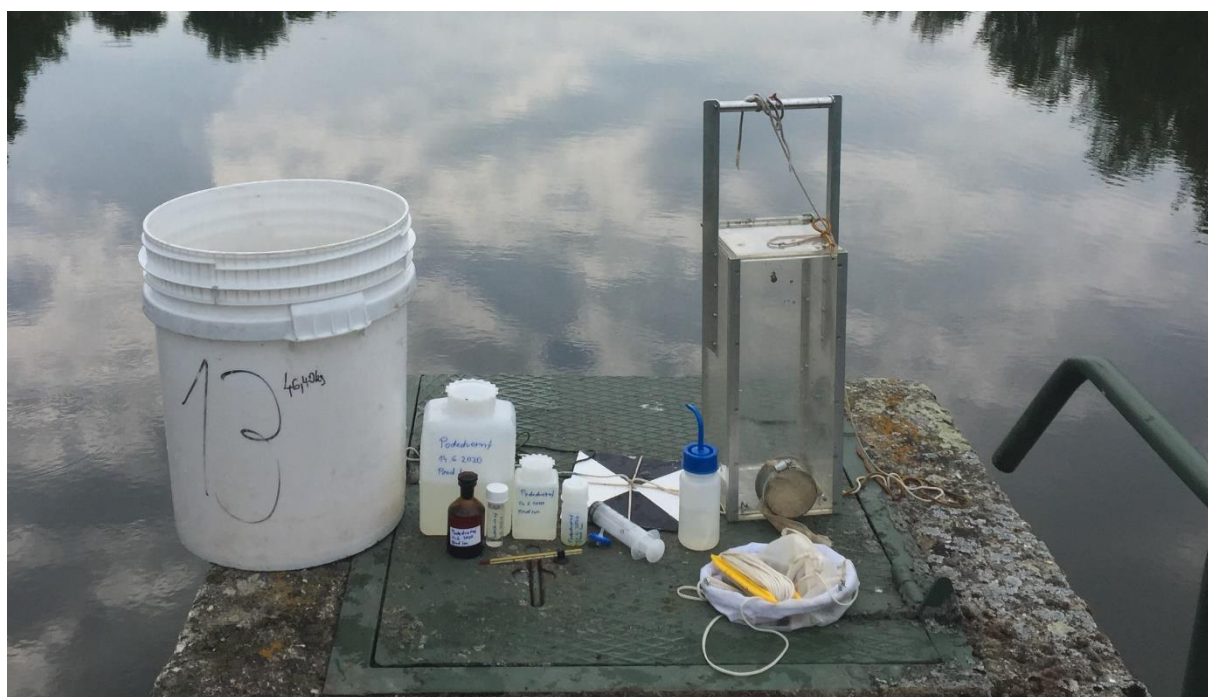
Obrázek 6: Výbava pro odebrání vzorků zooplanktonu. Zleva: Vědro o vhodném objemu pro 3 plné Patalasovy sběrače (3x10 l), vzorkovnice, teploměr, stříkačka s mikrofiltrem (0,45 \mu m), Secciova deska, stříčka pro oplach planktonní sítě, Patalasův odběrač, planktonní síť (80 \mu m).
