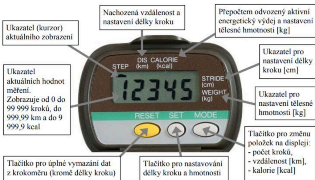
Obrázek č. 5: Displej krokoměru Yamax Digiwalker SW-700 s popisem ovládacích prvků (převzato od Sigmunda, 2012, 13)
