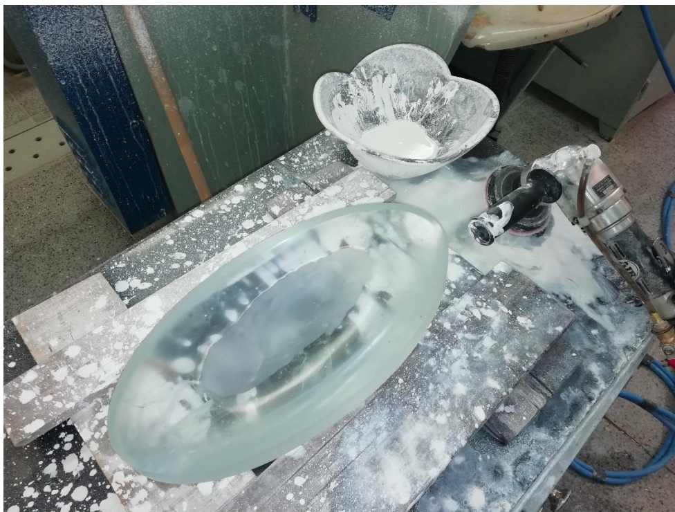
Obr. 28: Leštění pomocí volného leštiva
