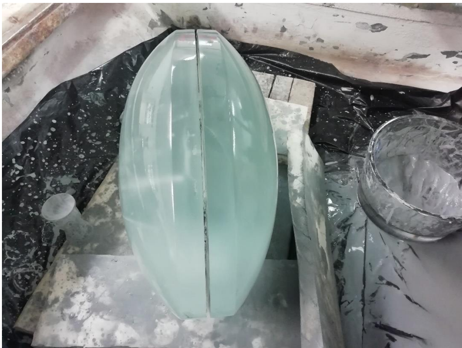
Obr. 20: Ruční broušení objektu pomocí volného brusiva; tzv. jemnění
