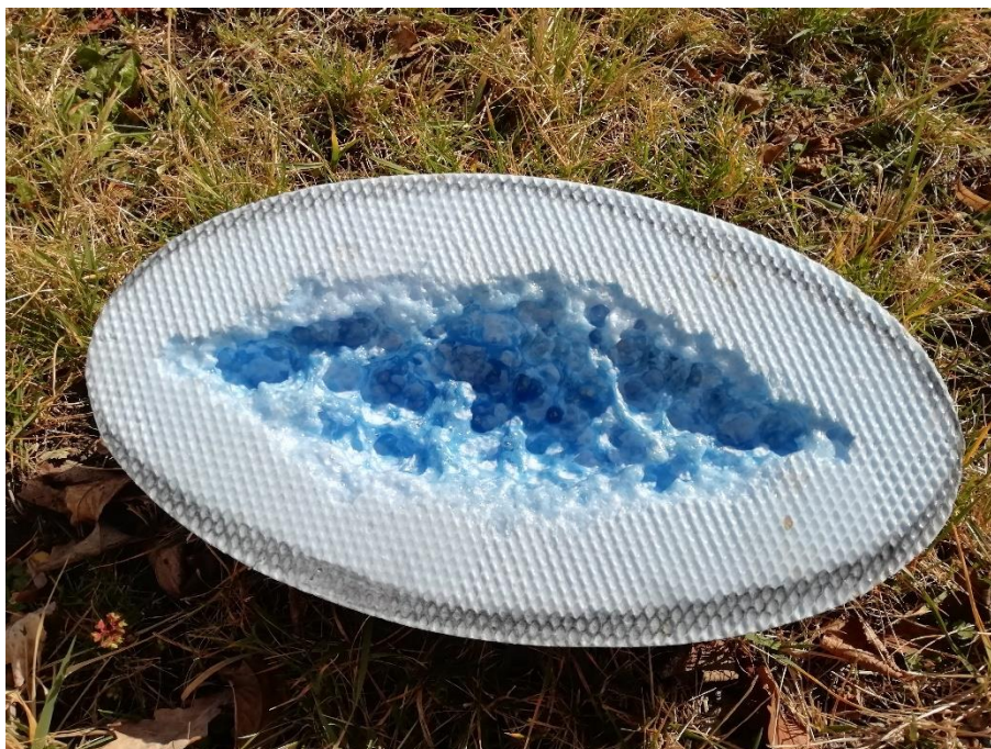
Obr. 7: Původní dutina získaná pomocí ředidla; dutina byla nakonec vytvořena pomocí pískovací pistole
