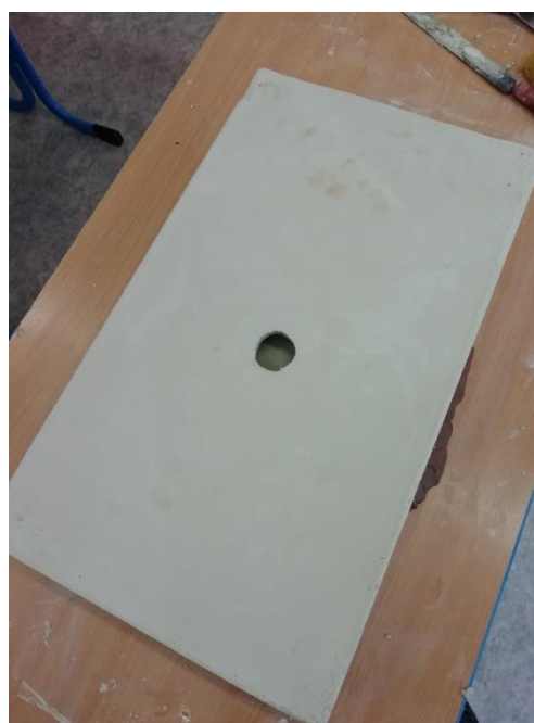
Obr. 11: Otvor pro nalévání lukoprenové hmoty
