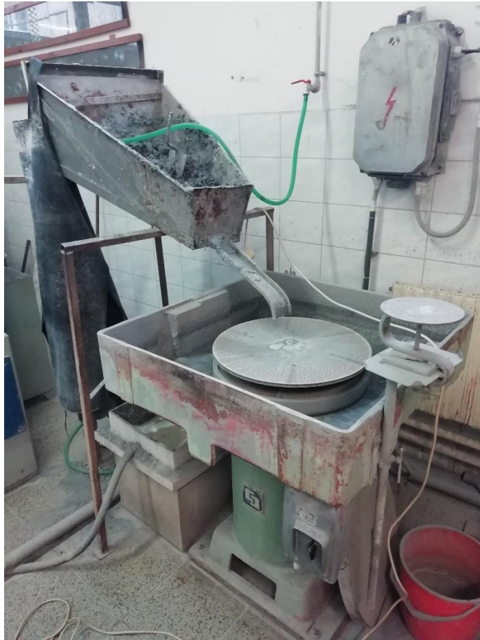
Obr. 16: Hladinařský stroj pro hrubé broušení
