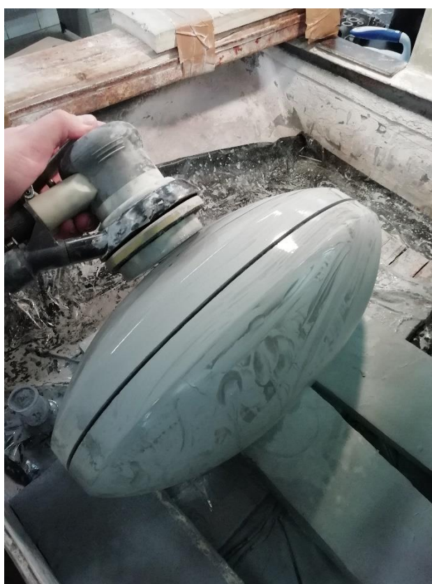
Obr. 21: Broušení objektu pomocí vzduchové brusky
