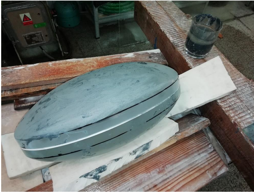
Obr. 18: Hrubé broušení vnějších ploch pomocí volného brusiva
