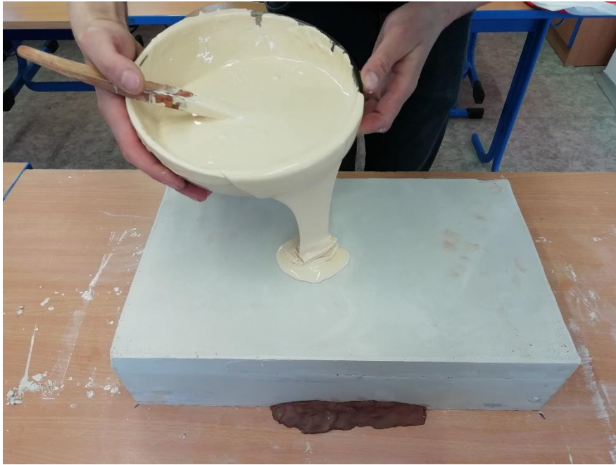
Obr. 12: Nalévání lukoprenové hmoty do sádrové formy
