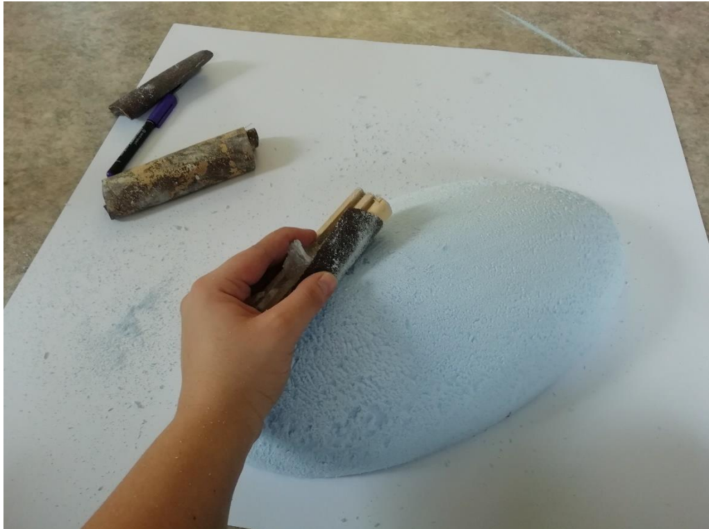
Obr. 5: Zahlazení vytvořeného tvaru pomocí brusného papíru
