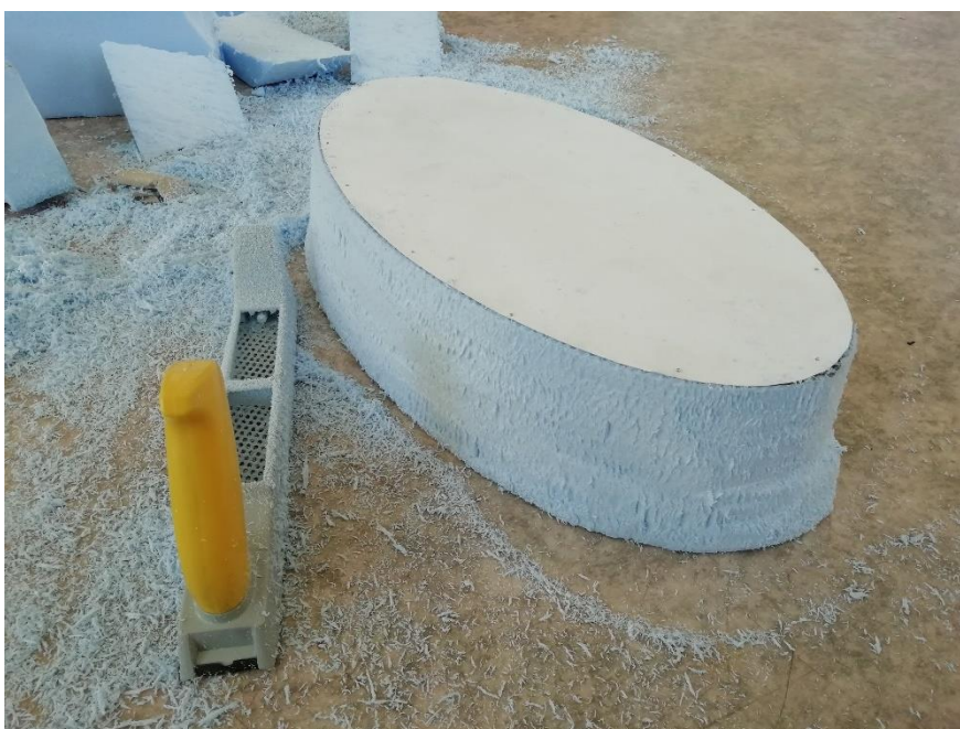
Obr. 4: Ořezaný polystyren a následné škrabání pomocí hoblíku na polystyren
