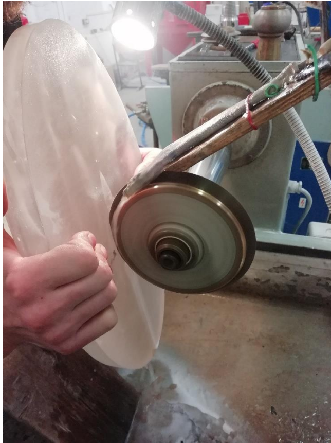
Obr. 22: Broušení klínového řezu na kuličském stroji; příprava po následné pískování dutiny
