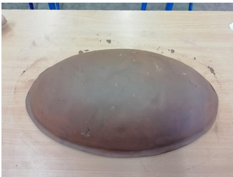
Obr. 8: Tvar z extrudovaného polystyrenu pokrytý hliněnou plackou
