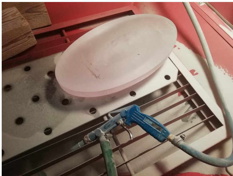
Obr. 23: Pískování organické dutiny v pískovacím stroji
