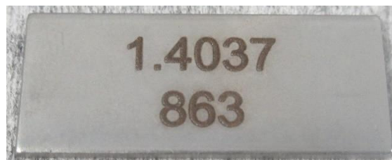
Obrázek 5 Kupón před mořením
