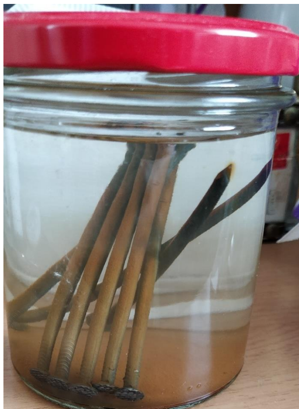
Obrázek 31 Hřebíky ve slaném roztoku (po týdnu)
