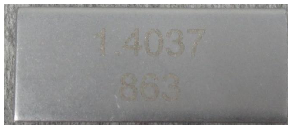
Obrázek 6 Kupón po moření
