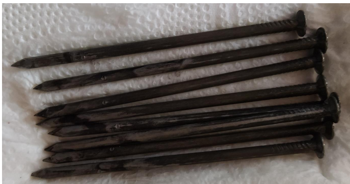
Obrázek 34 Hřebíky před očištěním kyselinou citronovou
