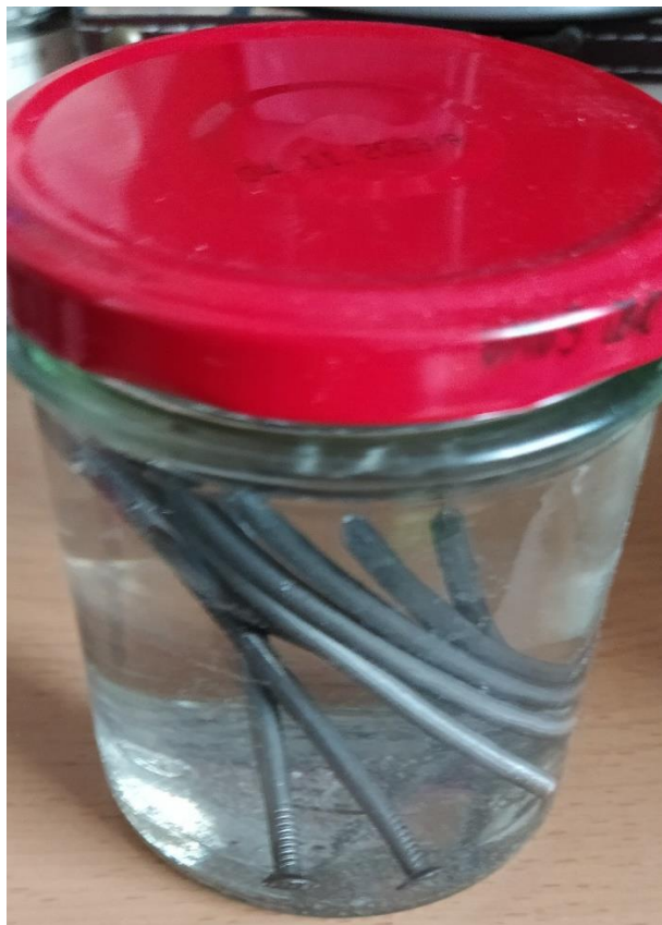
Obrázek 32 Hřebíky ve slaném roztoku (den první)
