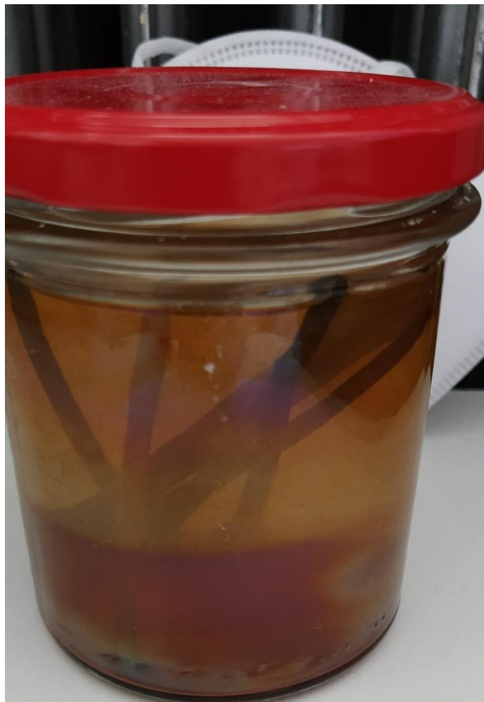
Obrázek 33 Hřebíky ve slaném roztoku (po dvou týdnech)
