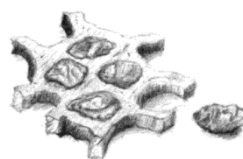
Obrázek 10: Zasklení oken, kaple sv. Kříže na Karlštejně
