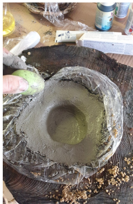
Obrázek 17 vložení a vytvarování směsi pomocí plastového vajíčka v dřevěném kruhu (archiv autora)
