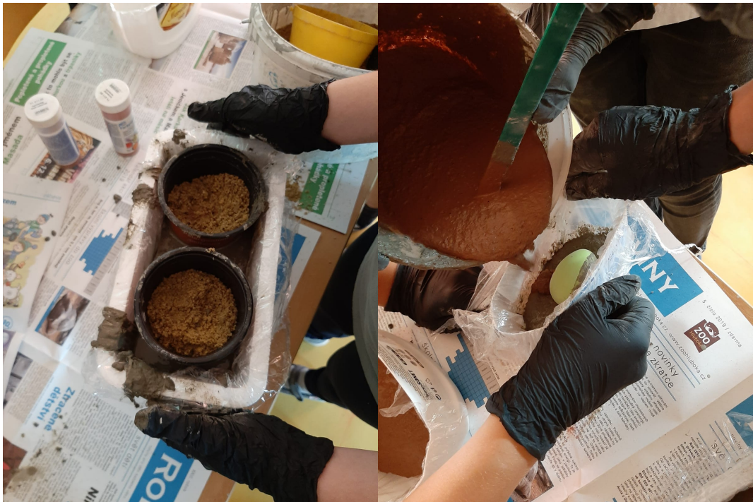
Obrázek 21 zatížení vnitřních forem pískem, lití probarvené směsi (archiv autora)
