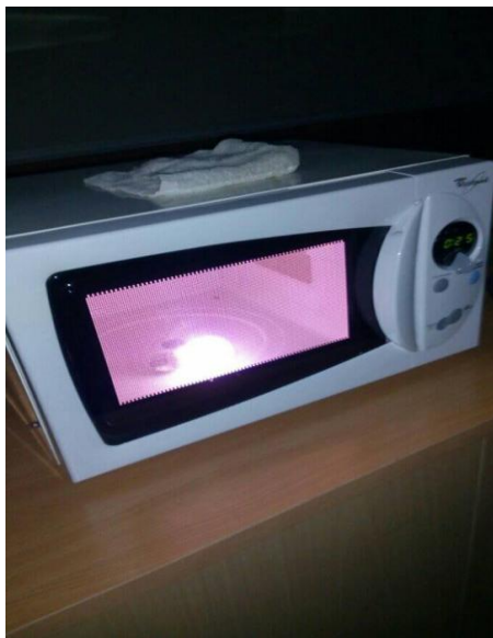
Obr. č. 39 Žárovka s wolframovým vláknem v mikrovlnné troubě, převzato a upraveno z [2]
