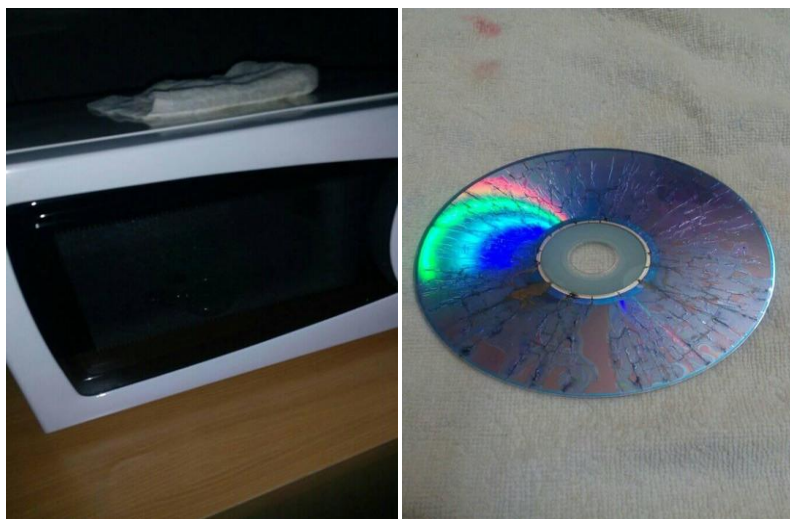
Obr. č. 42 a 43 CD disk při expozici a CD disk po vyjmutí z mikrovlnné trouby, převzato a upraveno z [2]
