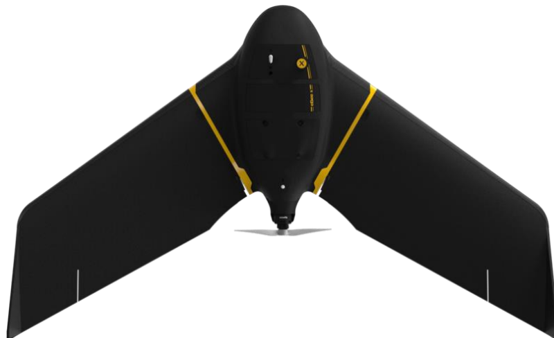
Obrázek 1, mapovací letoun SenseFly eBee X [5]
