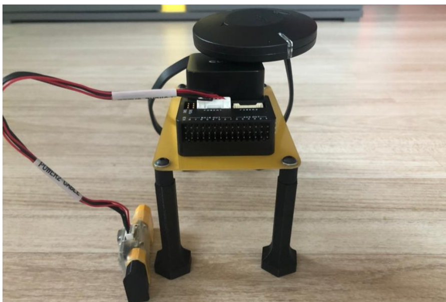
Obrázek 31, Laminátová konstrukce ke snížení vibrací
