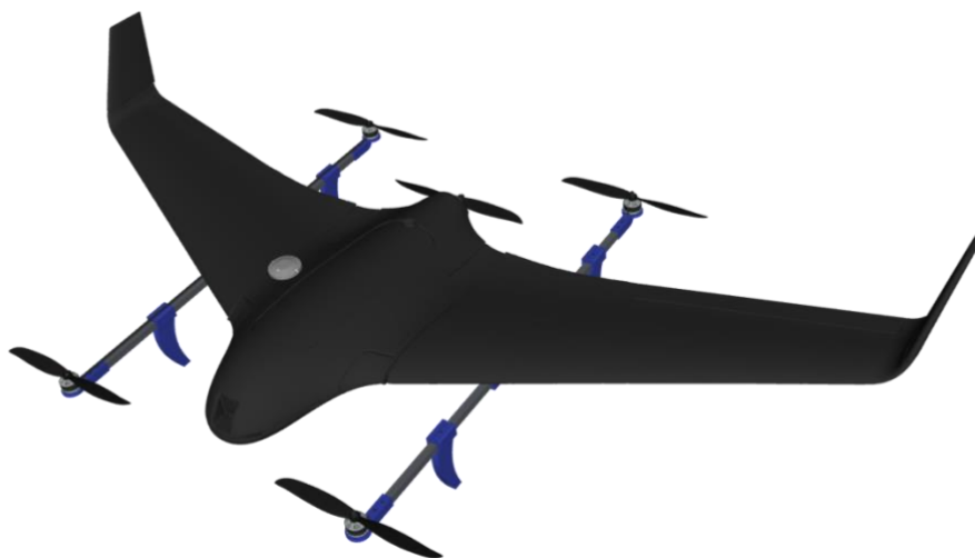
Obrázek 17, CAD model navrhovaného letounu
