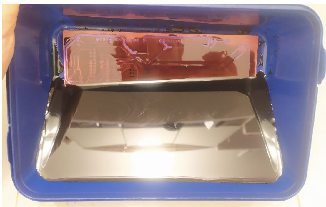
Obrázek 19: Osvícený Cuprextit v průběhu leptání
