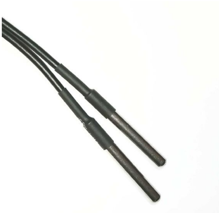
Obrázek 14: Zapouzdřený snímač DS18B20
