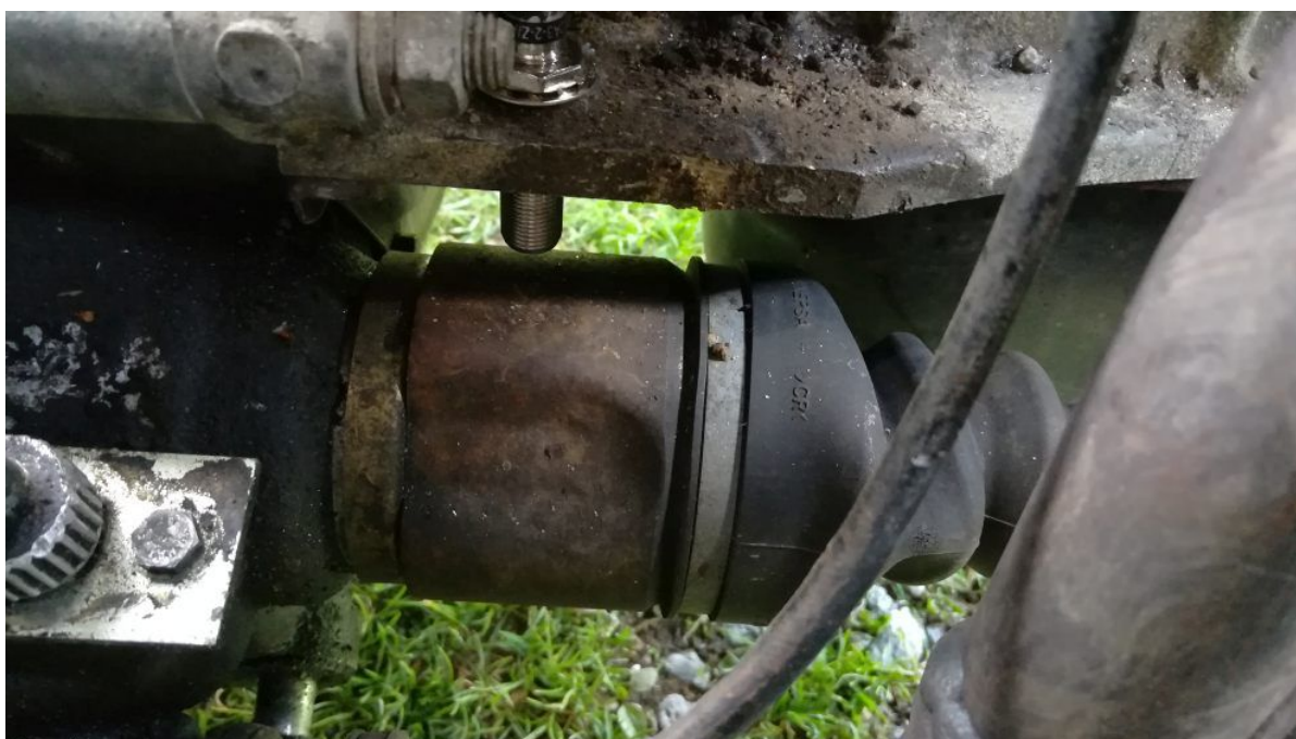
Obrázek 12: Instalovaný indukční snímač v bloku motoru pro snímání otáček homokinetického kloubu (nahoru uprostřed)
