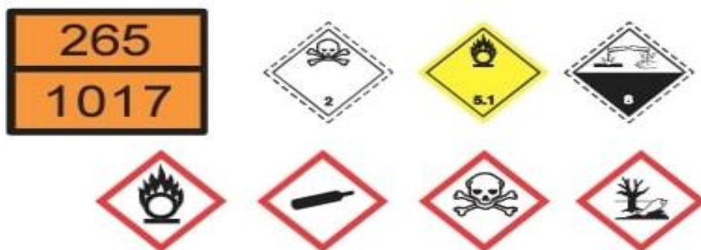
Obrázek 5 Značení chlóru podle UN, Kemler kódu a vystrážných symbolů Zdroj: Krajský úřad, 2019
