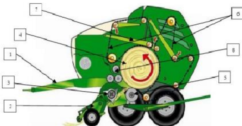
Obrázek č. 5 Svinovací lis s variabilní lisovací komorou (KRONE): 1-rám, závěs, 2-sběrací mechanismus, 3-spirální vkládací rotor, 4-lisovací komora, 5-pohyblivé dno, 6-svinovací pásy, 7-napínací mechanismus svinovacích pásů, 8-vázací mechanismus (Kumhála, 2007)
