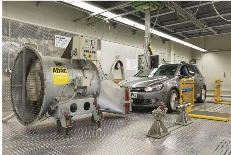
Obrázek 1.6 - Test softwarových úprav na motoru 2.0 TDI u společnosti ADAC (Adac.de, 2018)
