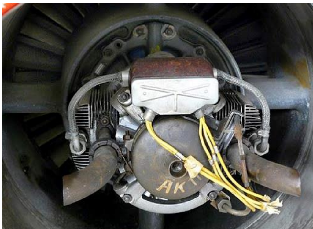
Obrázek 1.8: Motor typu boxer, který startoval proudový motor Jumo 004 B, (lucafusari.altervista.org, 2016)
