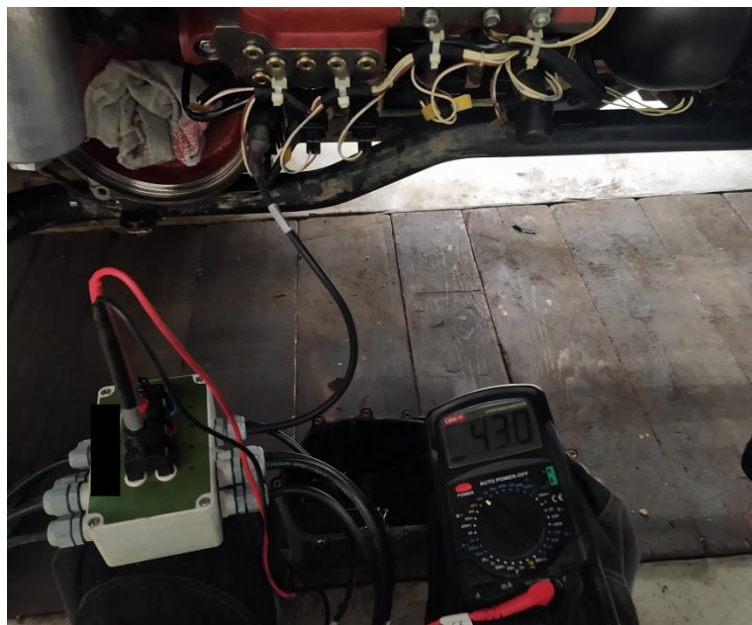
Obrázek 4.9 Měření odporů elektromagnetických cívek
