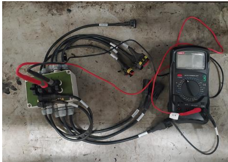
Obrázek 4.8 – Multimetr s adaptérem pro měření snímačů a elektromagnetických cívek
