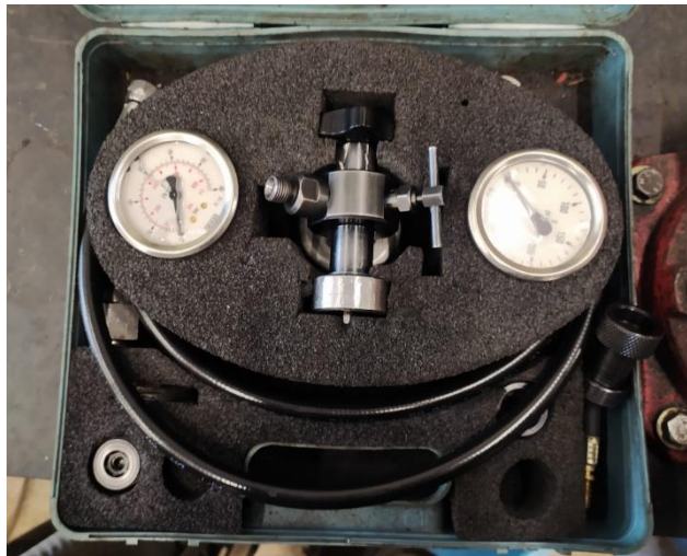
Obrázek 3.3 – Plnicí a kontrolní zařízení pro dusíkové akumulátory
