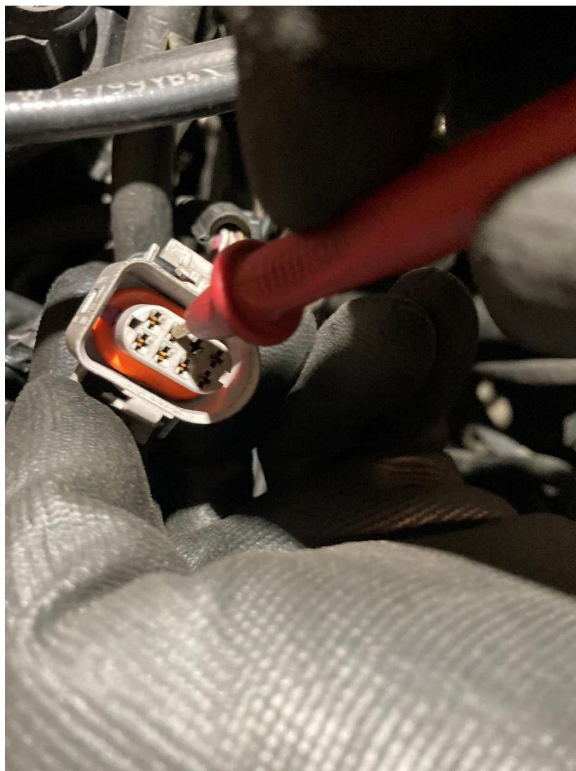
Obrázek 4.8 - Kontrola škrticí klapky
