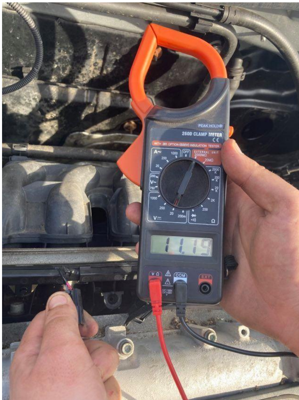
Obrázek 4.7 - Kontrola napájení vstřikovacího ventilu
