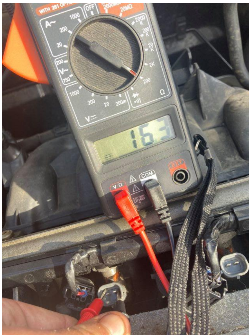
Obrázek 4.6 - Měření odporu vstřikovacího ventilu
