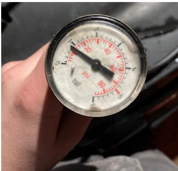
Obrázek 4.10 - Tlak při volnoběžných otáčkách
