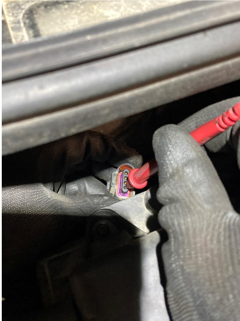
Obrázek 4.5 - Kontrola snímače tlaku v sacím potrubí
