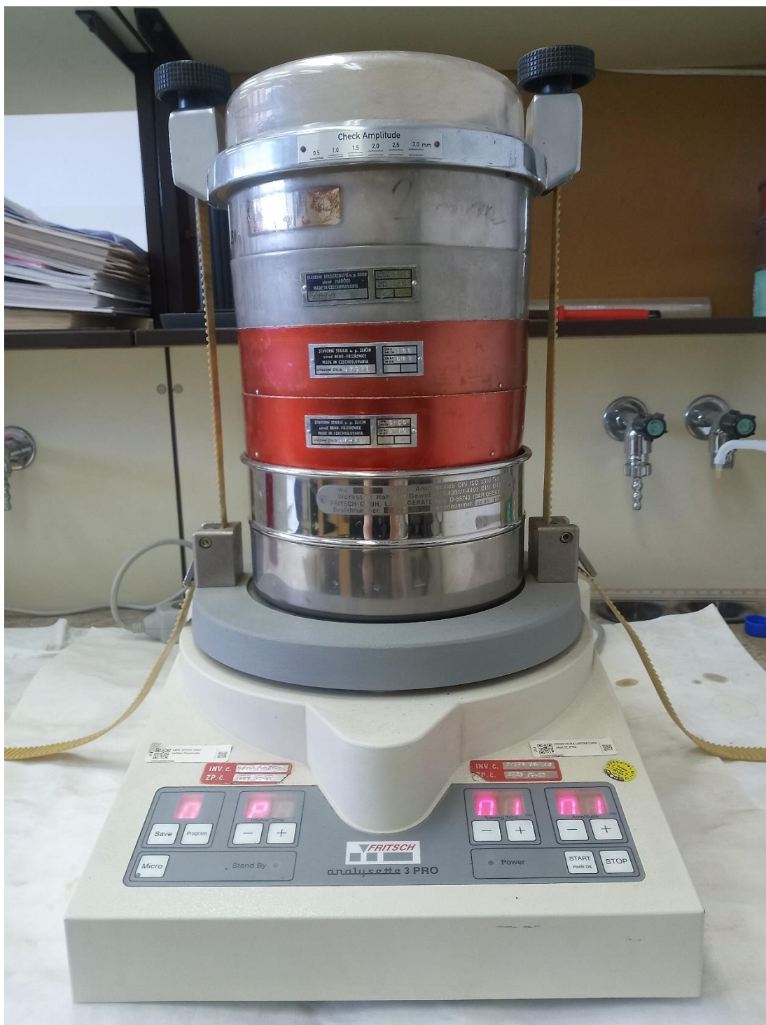
Obrázek 4.5: Laboratorní prosévačka FRITSCH ANALYSETTE 3 PRO se sadou sít (Foto Eva Klenotová)
