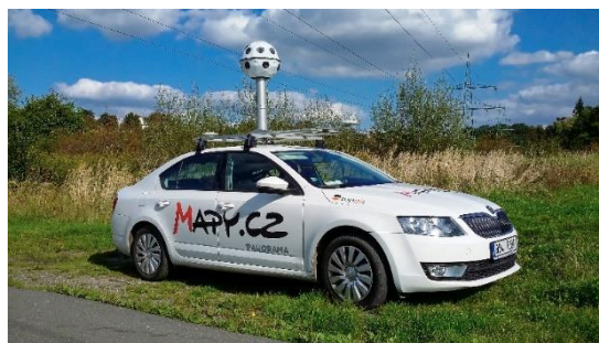
Obrázek 1.5: Mapovací automobil TopGis (TopGis, s.r.o., 2018)
