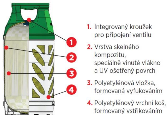
Obr. 33 Složení kompozitní lahve na LPG (MM Science Journal, 2010)
