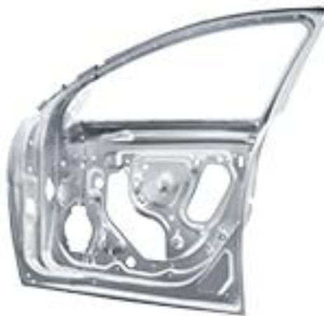
Obrázek 2.9: Vnitřní díl dveří automobilu, vyrobený technologií tailored welded blanks (Baosteel, 2021).
