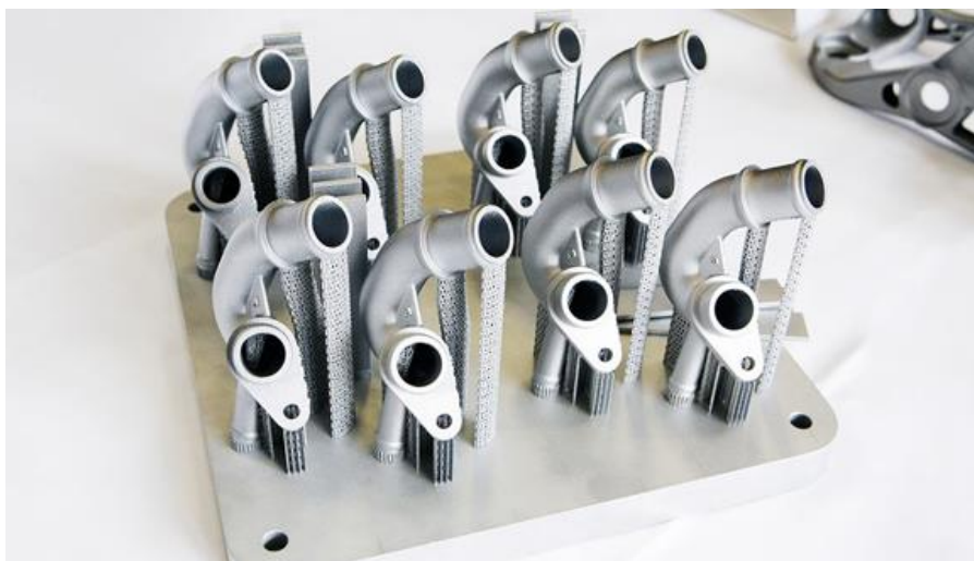
Obrázek 2.11: Vodní konektor pro motor Audi W12 vyrobený metodou 3D tisku (METAL AM, 2018).
