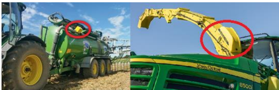
Obrázek 2.14: Zařízení HarvestLab umístěný na cisterně pro aplikaci tekutých statkových hnojiv (vlevo) a na výmetné rouře řezačky (vpravo). (Goualan, 2017; deere.cz, 2021 a)
