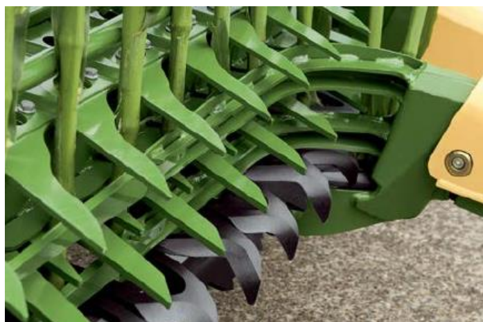
Obrázek 2.1: Nůžkový řez adaptéru Krone EasyCollect (krone.de, 2020 c)
