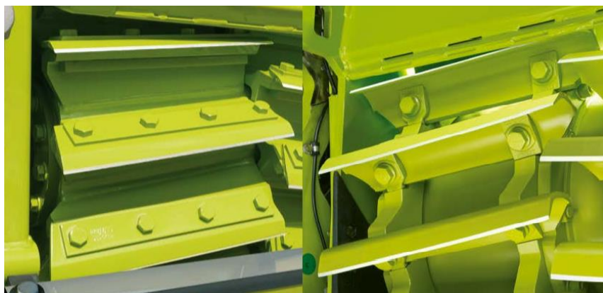
Obrázek 2.4: Buben V-CLASSIC (vlevo) a buben V-MAX (vpravo) (special.claas.com, 2020)
