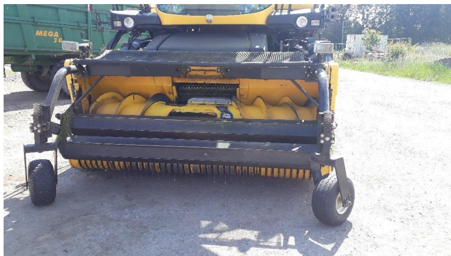
Obrázek 2.17: Adaptér pro sběr řádků New Holland 300 FP.
