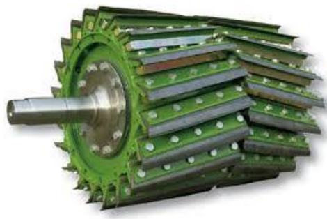
Obrázek 1.2: řezací buben řezačky Krone Big X (Fríd, 2015)
