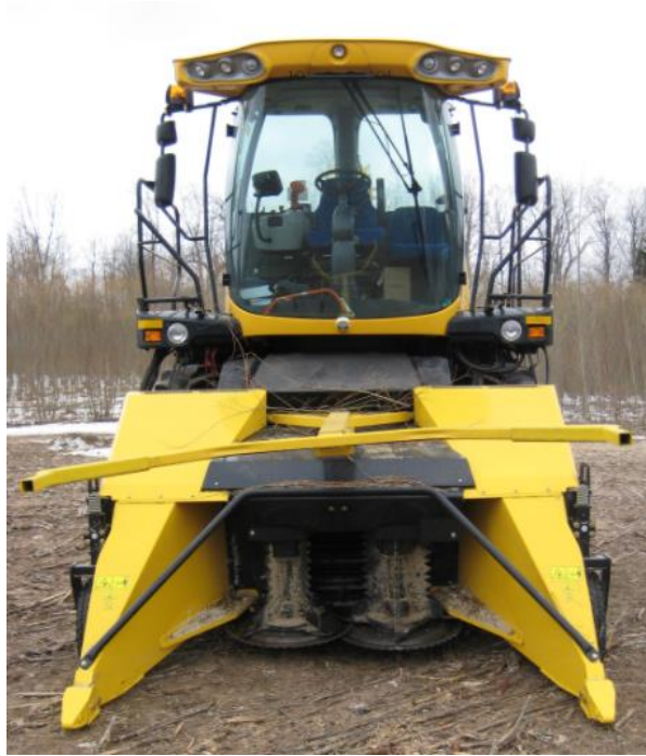
Obrázek 2.19: Adaptér pro sklizeň rychlerostoucích dřevin New Holland. (digitalcommons.esf.edu, 2009)
