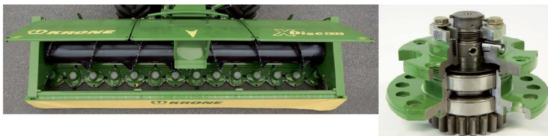
Obrázek 2.3: Adaptér XDisc vlevo a detail systému SafeCut vpravo (krone.de, 2020 c)
