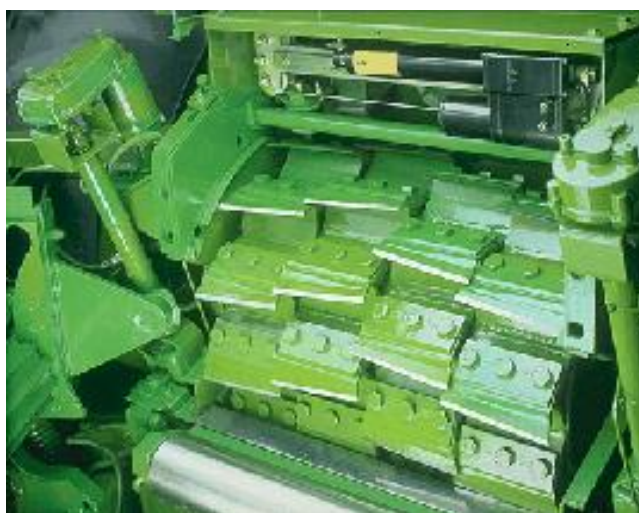
Obrázek 2.9: Řezací buben John Deere. (salesmanual.deere.com, 2008)
