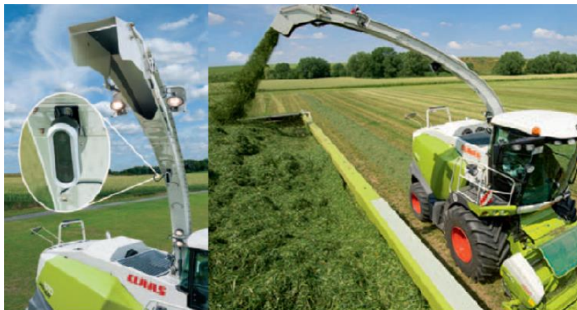
Obrázek 1.7: Odhazová koncovka s kamerou (agrall.cz, 2020)
