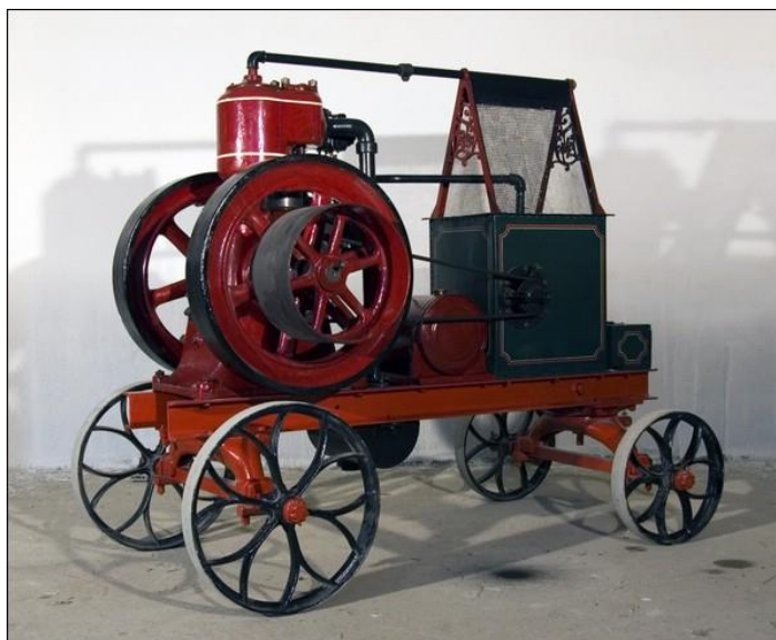
Obrázek 1.1: stabilní motor na vlastním podvozku (restauratorskadilna.cz, 2008)
