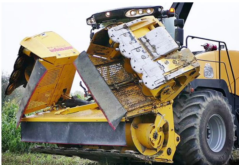
Obrázek 2.18: Adaptér pro přímou sklizeň Marangon, sklopná verze. (marangon.it, 2020 b)
