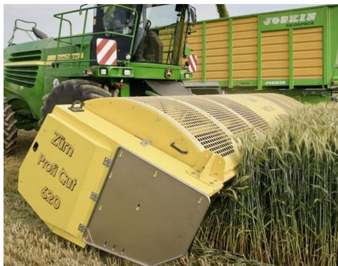
Obrázek 2.13: Adaptér na přímou sklizeň celých rostlin Zürn Profi Cut. (zurnuk.co.uk, 2015)
