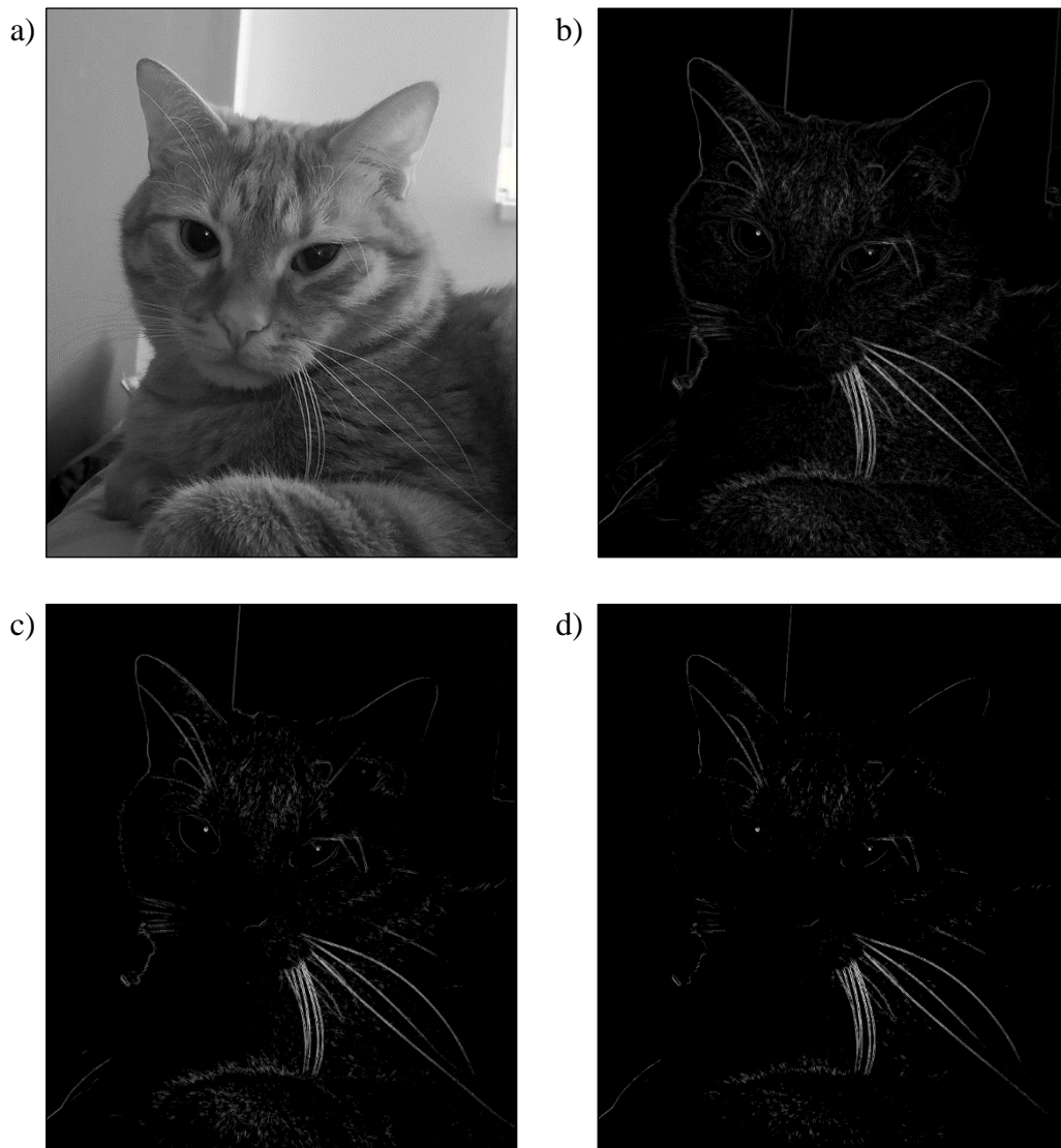
Obrázek 3.9: Obraz po aplikaci Sobelova operátoru, a) vstupní obraz, b) výsledný obraz pro práh o hodnotě 10, c) výsledný obraz pro práh o hodnotě 30, d) výsledný obraz pro práh o hodnotě 50
