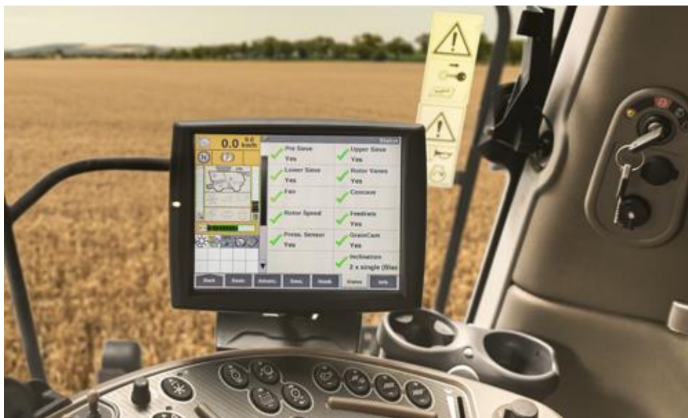
Obrázek 1.14: Monitor sklízecí mlátičky (Case IH, 2021)
