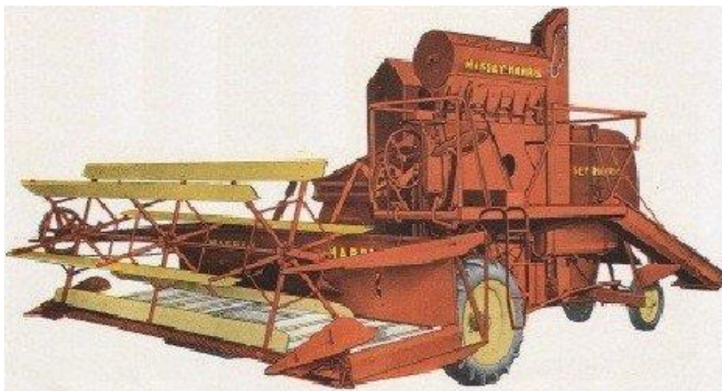
Obrázek 1.1: Sklízecí mlátička MH-21 (Agrodoctor.eu, 2004)
