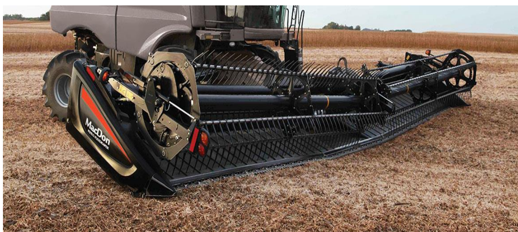
Obrázek 1.11: Flexibilní pásová lišta MacDon (MacDon.com, 2021)
