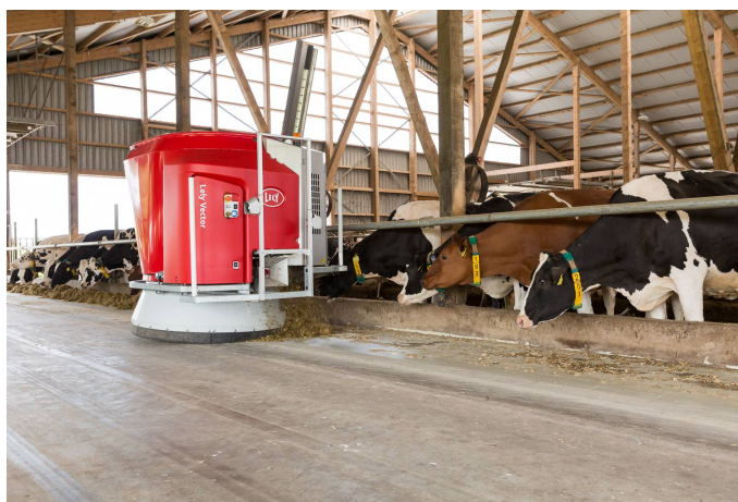
Obrázek 3.7: Aplikace krmiva Krmícím robotem
