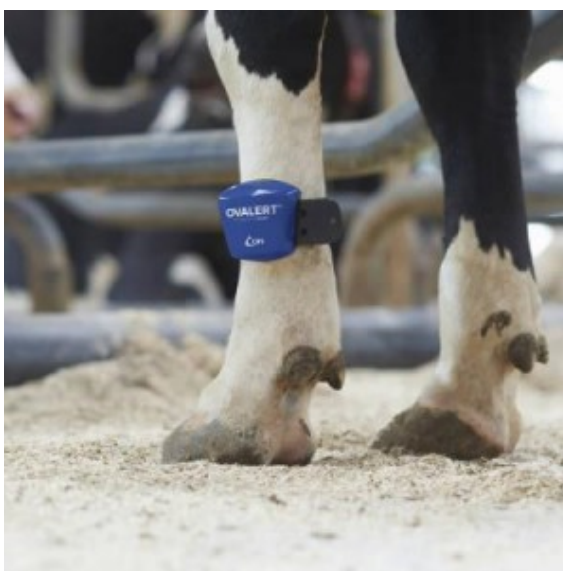
Obrázek 3.2: Pedometr umístěný na noze
