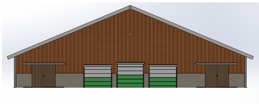
Obrázek 5.5: Sestava štítové konstrukce
