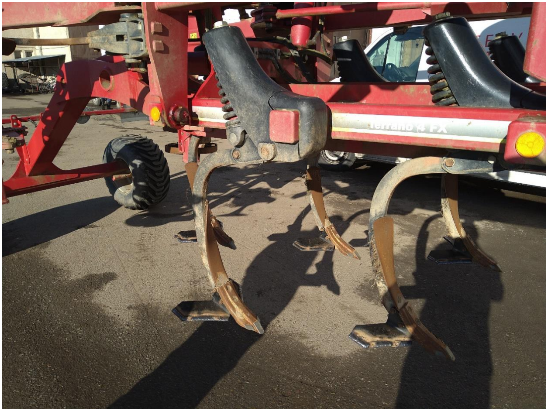
Obrázek 1.8: Pracovní orgány radličkového kypříče
