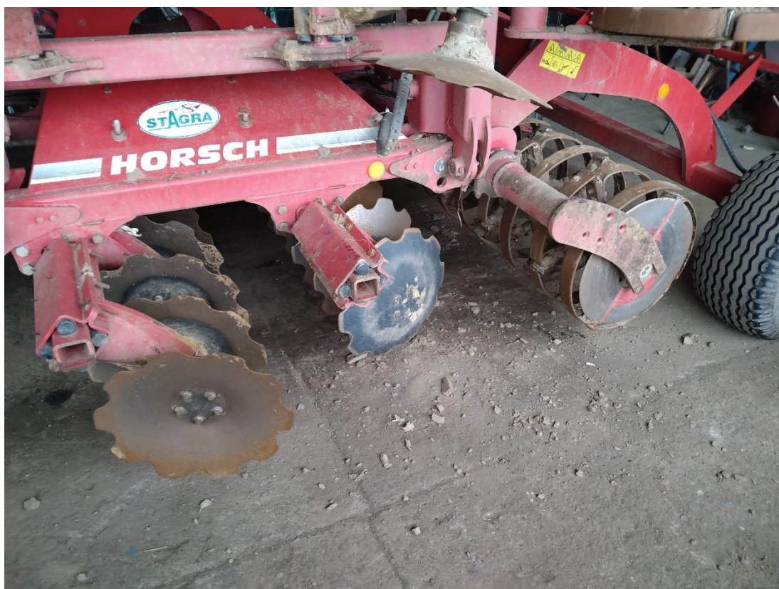
Obrázek 1.7: Pracovní části talířového kypřiče
