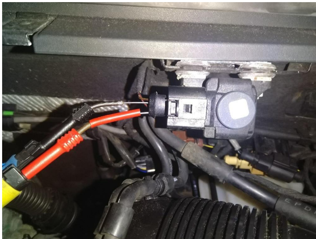
Obrázek 3.21: Připojení svorek ke konektoru snímače vstupních otáček
