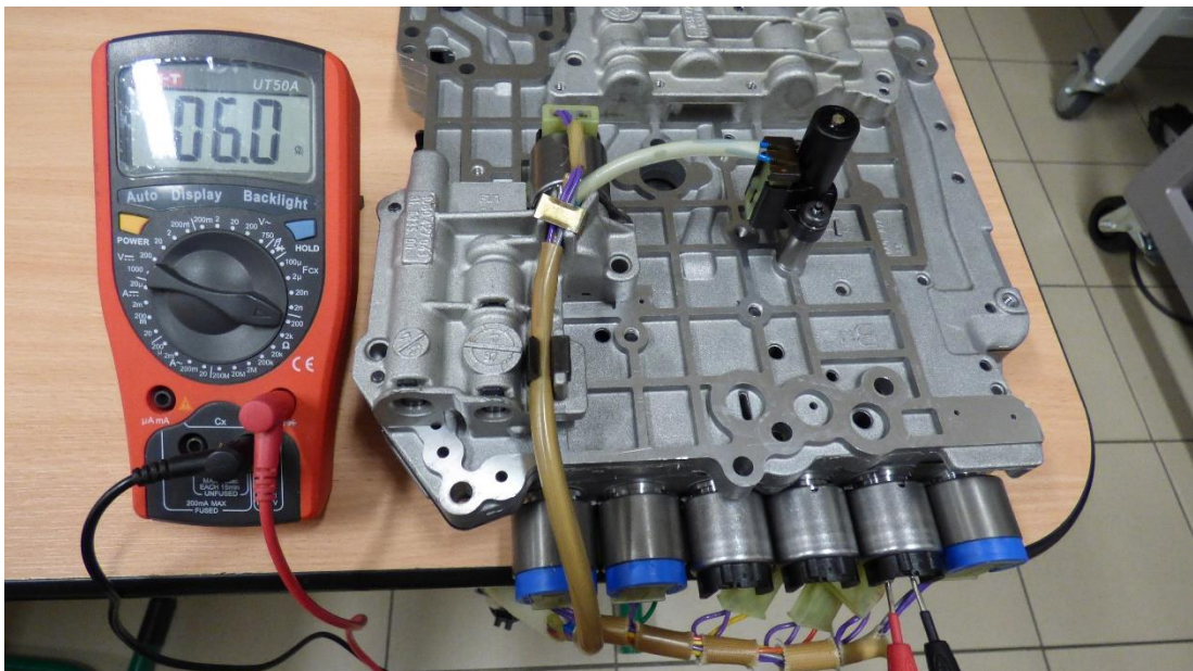
Obrázek 3.10: Připojení multimetru k regulačnímu ventilu N218
