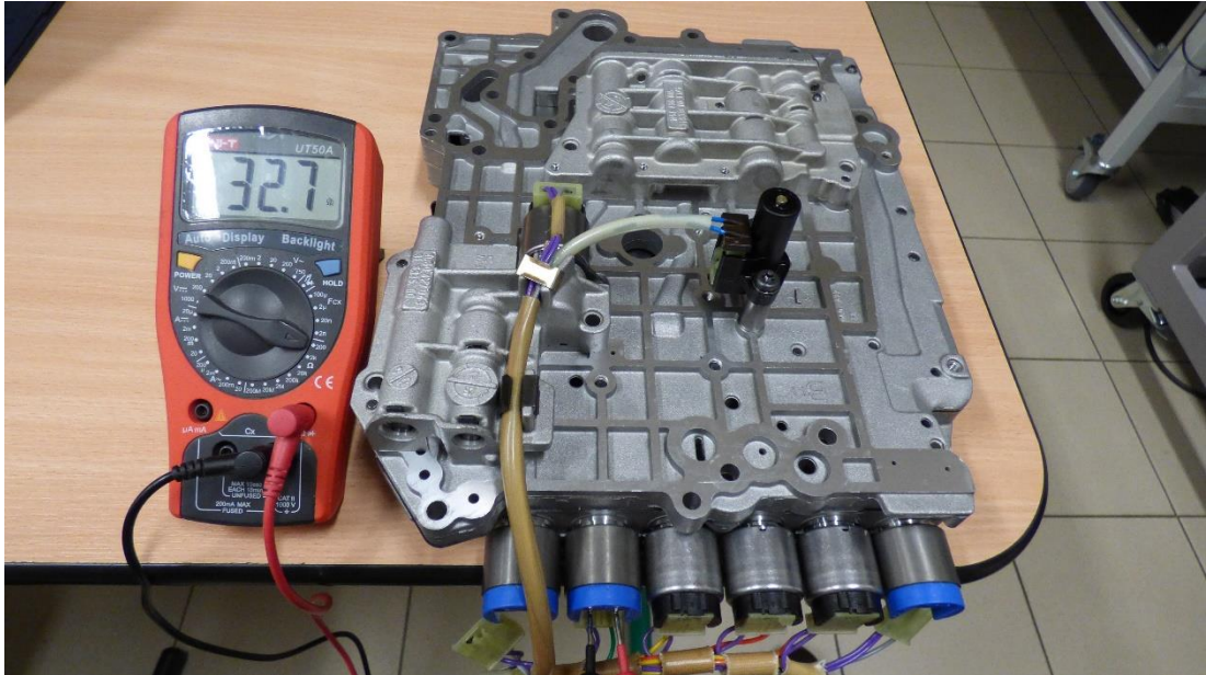
Obrázek 3.12: Připojení svorek multimetru k regulačnímu ventilu N89
