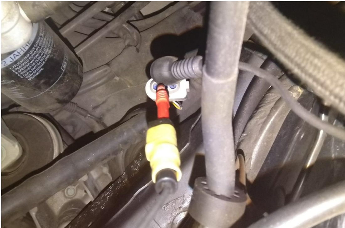
Obrázek 3.19: Připojení měřících svorek ke snímači vstupních otáček
