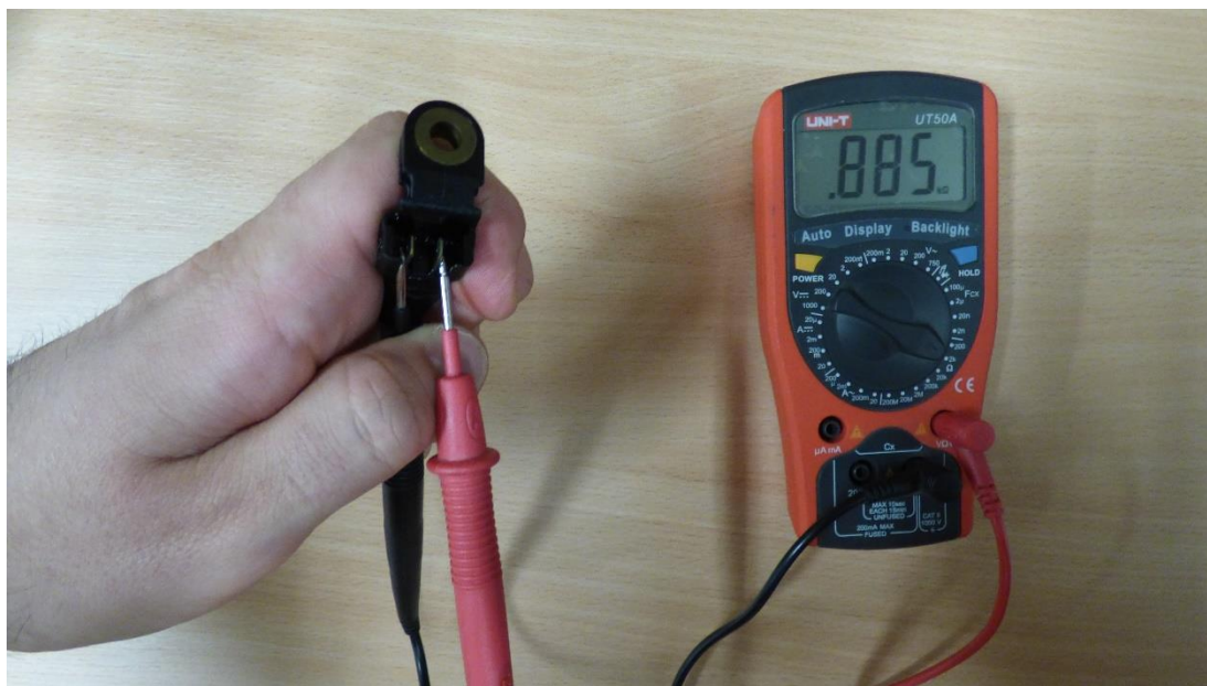
Obrázek 3.6: Připojení svorek multimetru ke snímači výstupních otáček
