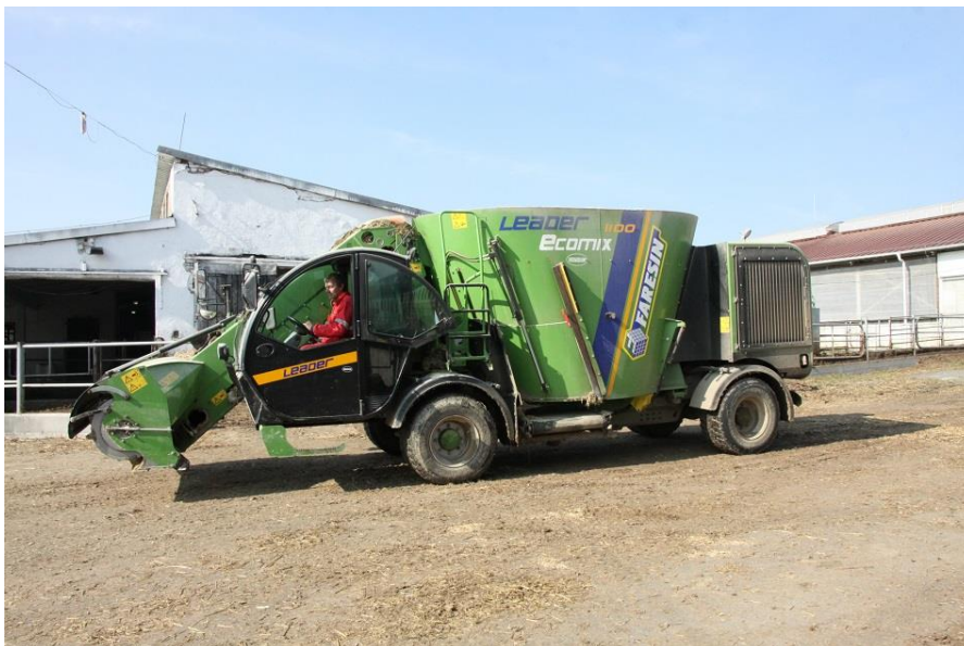
Obrázek 4: Samojízdný krmný vůz Faresin
