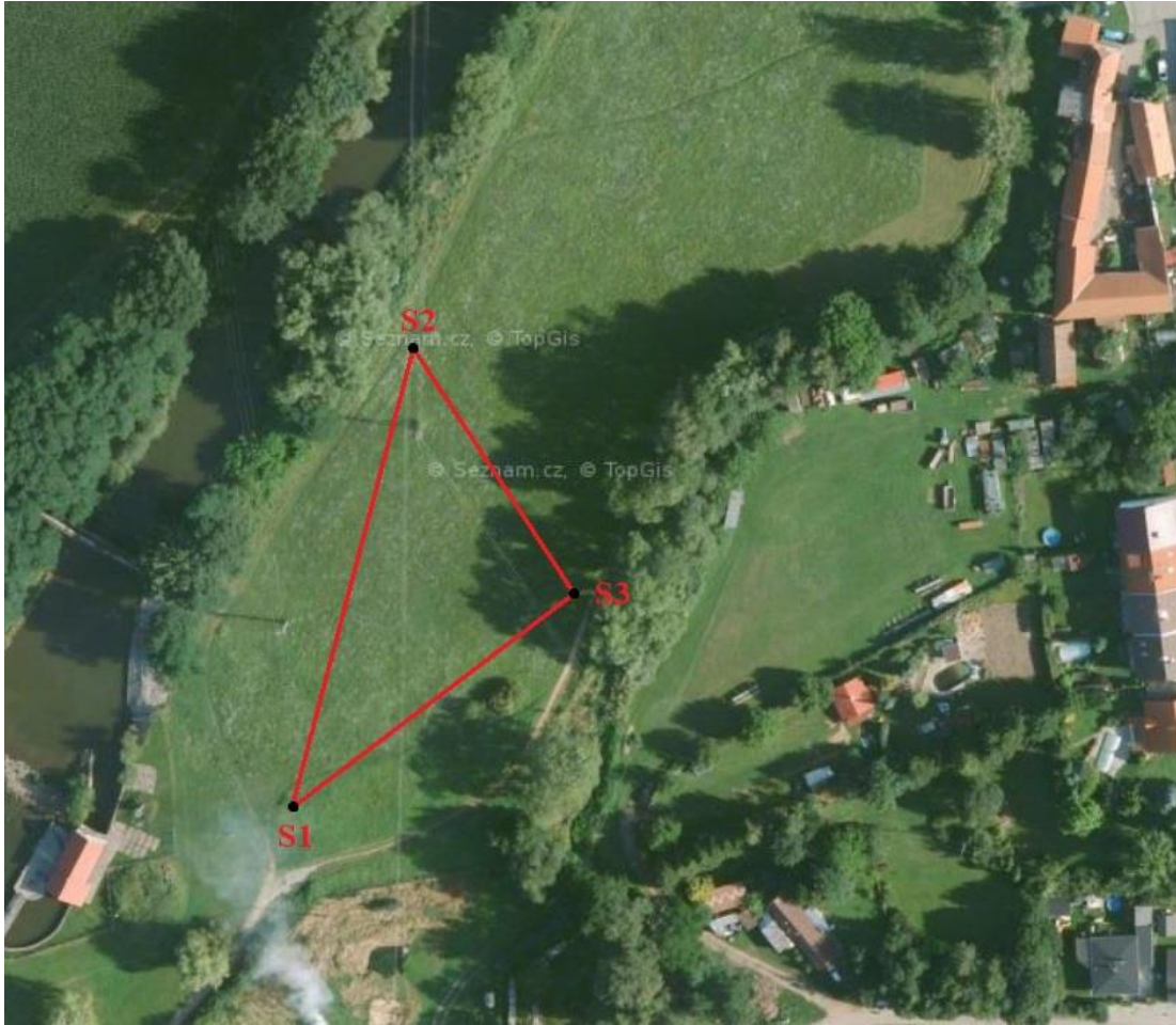
Obrázek 3.2: Zkonstruování testovacího trojúhelníka v terénu pro test totální stanice (Mapy.cz)
