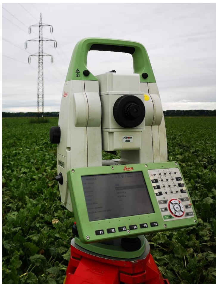
Obrázek 4.25: Leica TS16 R500 (vlastní)
