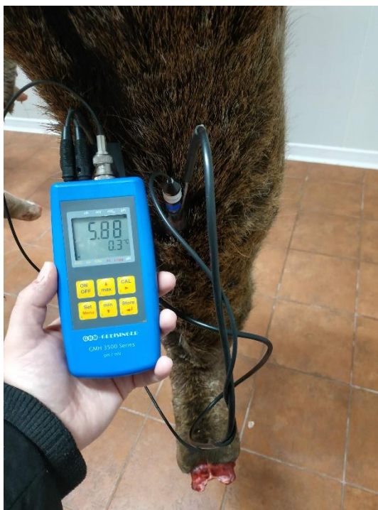
Obrázek 3.4: Měření hodnoty pH daňčího masa v chladícím boxu (Vlastní)
