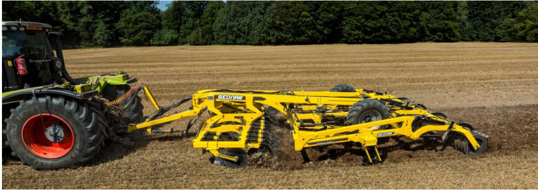
Obrázek 1.13: Kombinovaný kypřič Bednar s talířovým kypřičem a dlátovým kypřičem pro zpracování ve větší hloubce (Bednar.com, 2021)
