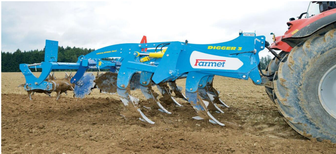
Obrázek 1.16: Dlátový kypříč Farmet vybavený válci s velkými hroty pro kvalitní rozdrobení hrud (Farmet.cz, 2021)
