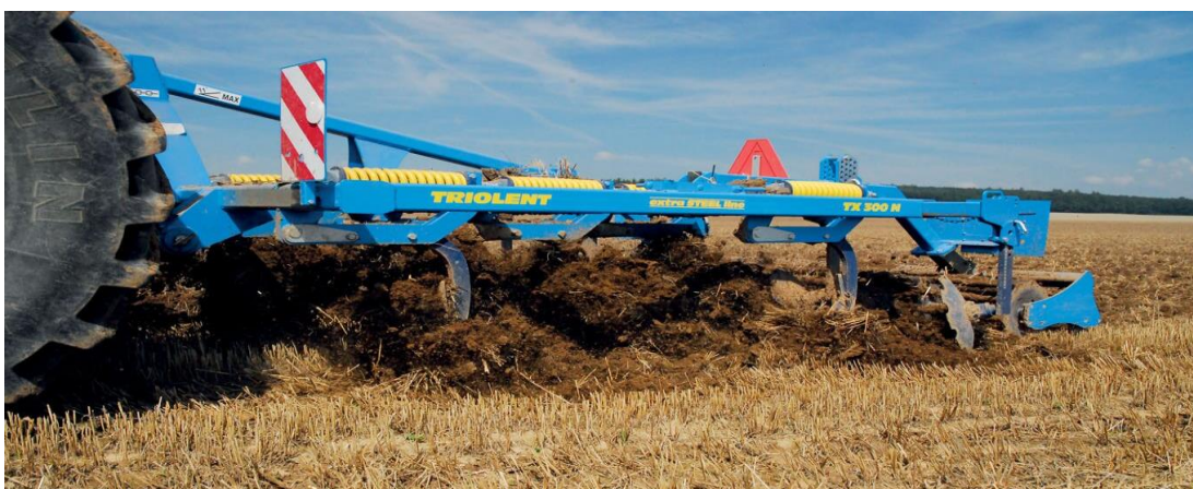
Obrázek 1.9: Radličkový kypříč Farmet jištěný vinutou pružinou (Farmet.cz, 2021)
