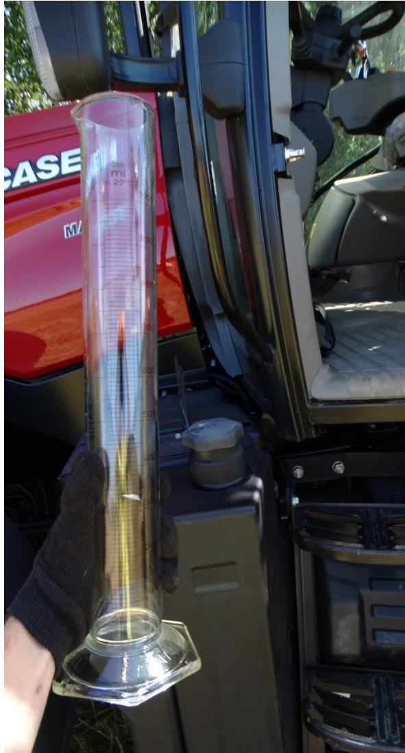
Obrázek 3.22: Odměrný válec pro měření množství PHM při doplňování nádrže
