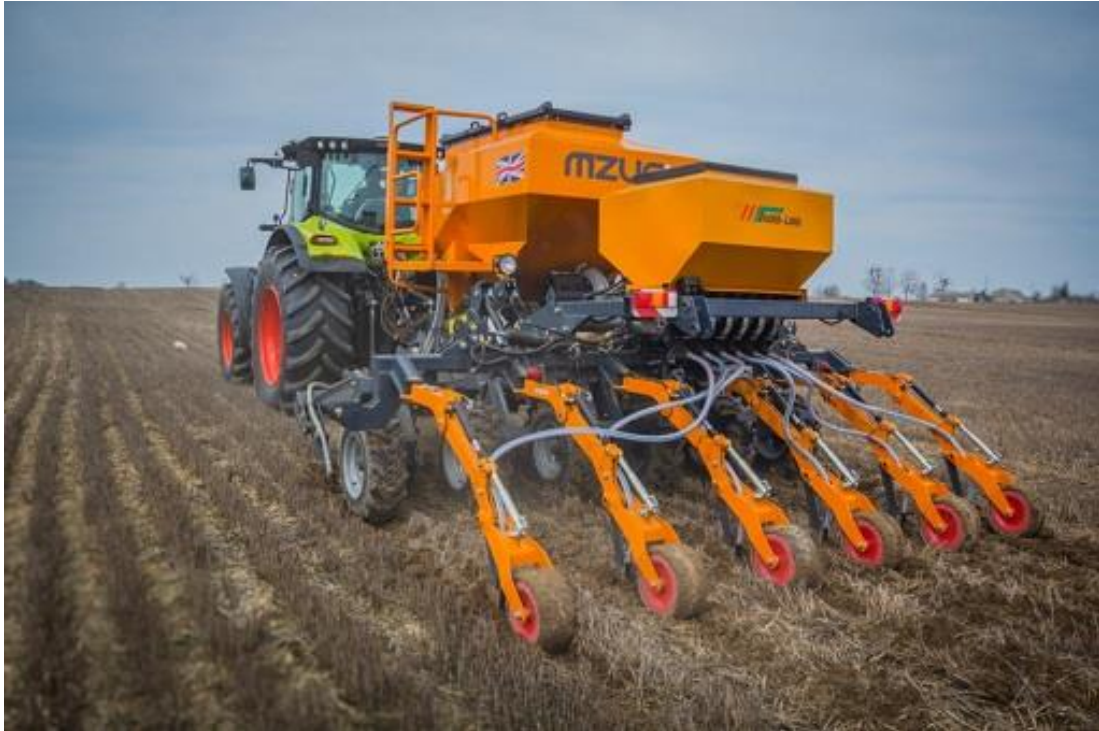
Obrázek 1.7: Technologie jednoho přejezdu Mzuri a setí do nezpracované půdy (Cenyrolnicze.pl, 2017)
