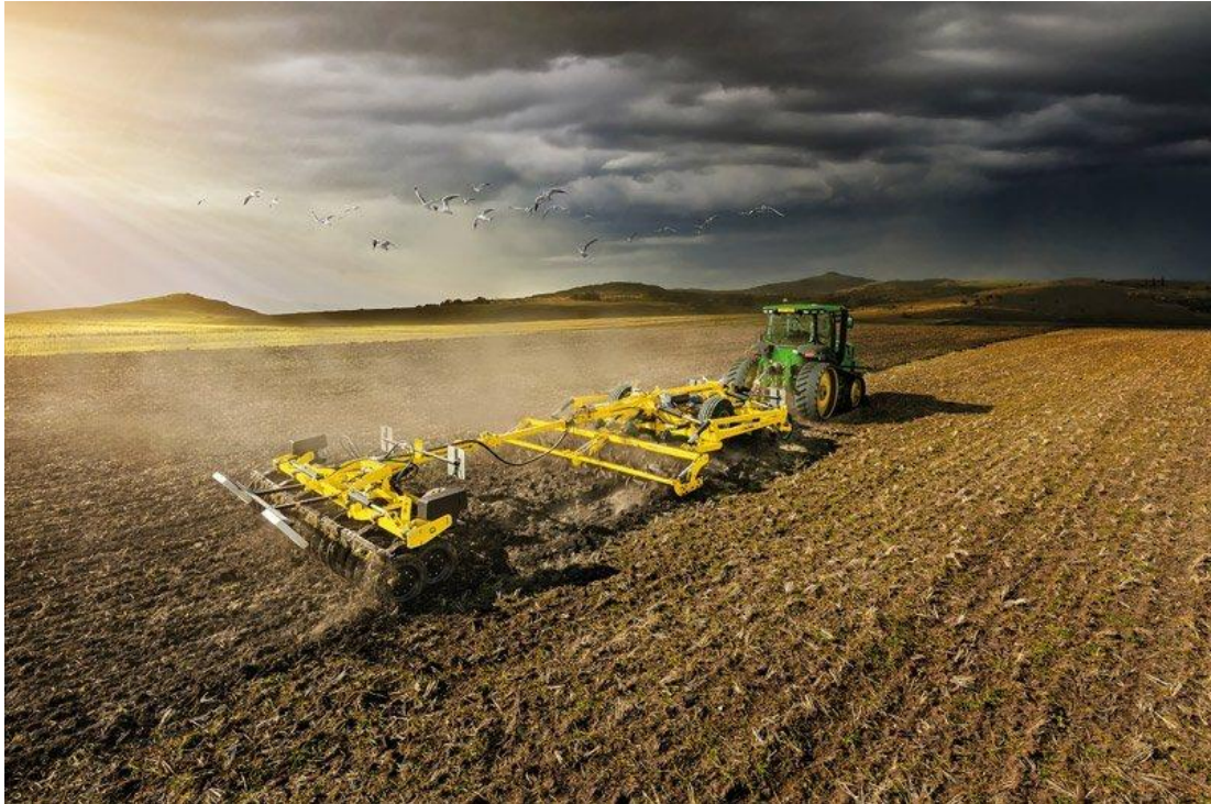
Obrázek 1.5: Zpracování půdy bez orby kypřením sloučené spolu s drcením hruď pěchem (Bednar.com, 2021)
