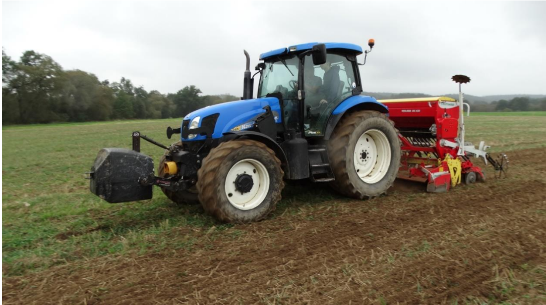
Obrázek 4.14: Setí tritikale v kombinaci s kolovým traktorem New Holland T6050 a secí kombinací Pöttinger Vitasem 302 ADD s kypřičem s horizontálním nožovým rotorem Pöttinger Lion 3002
