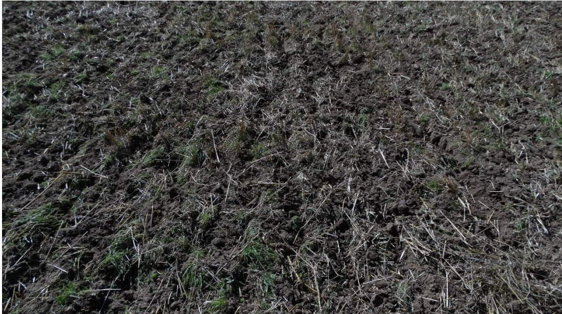
Obrázek 4.8: Místa na zkušební ploše, které kotoučový kypřič nedokázal ideálně zpracovat vlivem dlouhých strništních zbytků a plevelů
