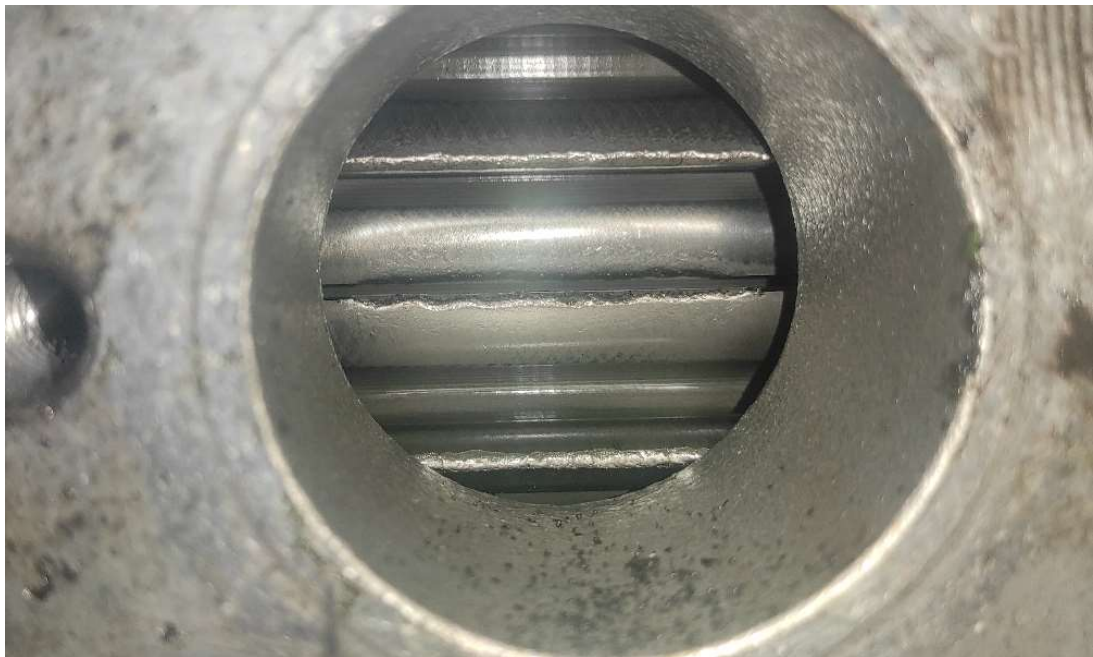
Obrázek 4.7: Poškozená ozubená kola čerpadla
