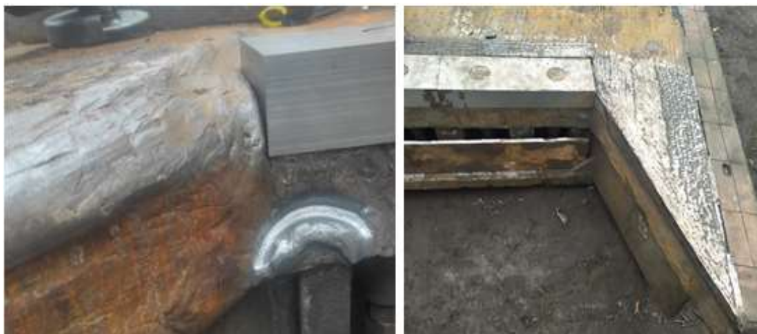
Obrázek 4.2: Střížná část saní před renovací (vlevo) a po renovaci (vpravo)
