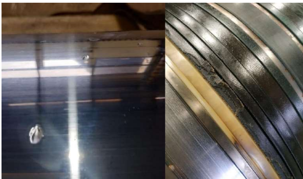
Obrázek 4.4: Zleva – poškození pístnice; těsnící prvky pístu
