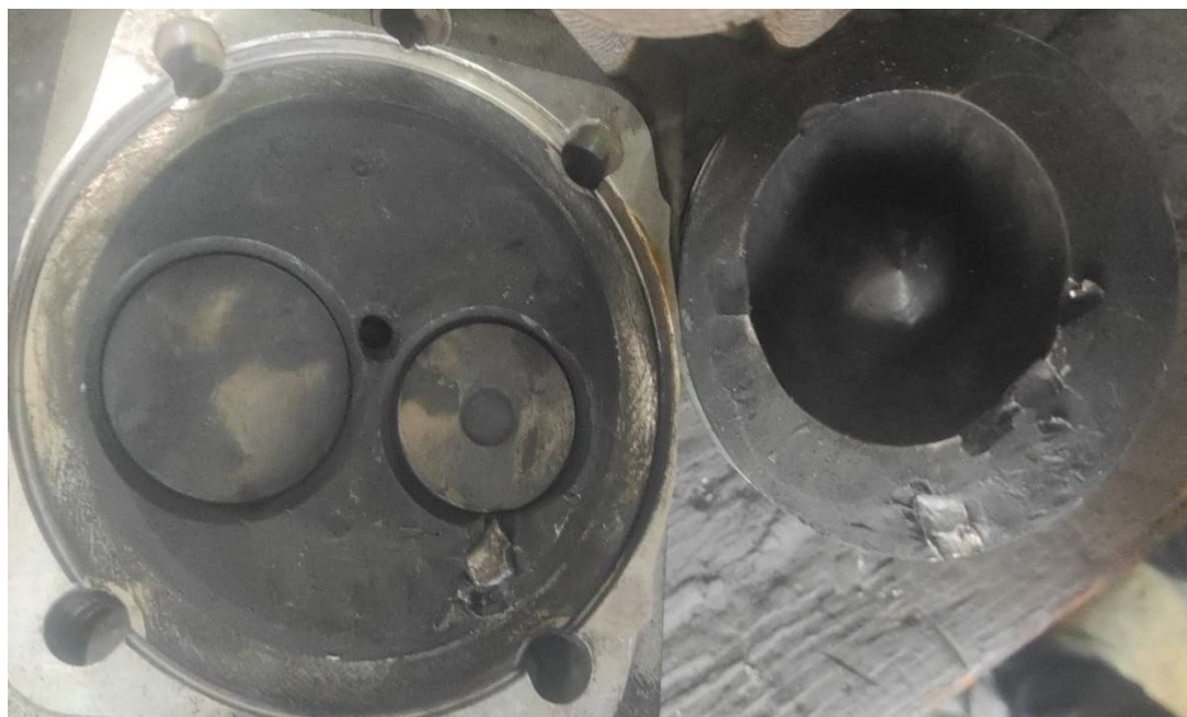
Obrázek 4.8: Poškozená hlava a píst na šestém válci
