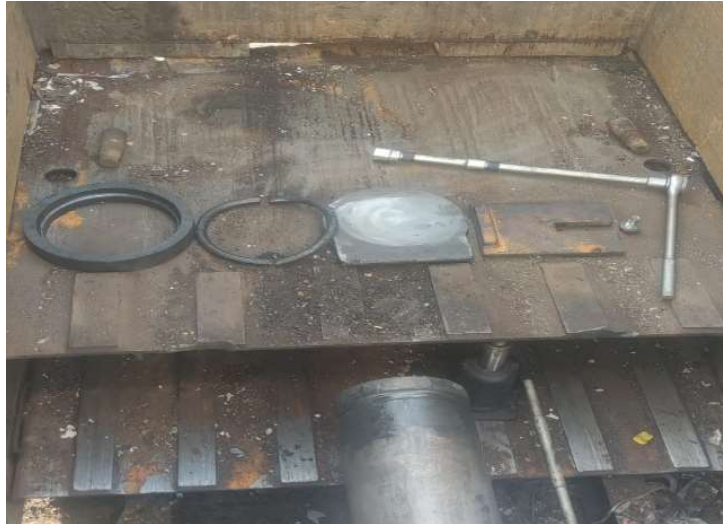
Obrázek 4.1: Spojovací prvky střížných saní s hydraulickými válci
