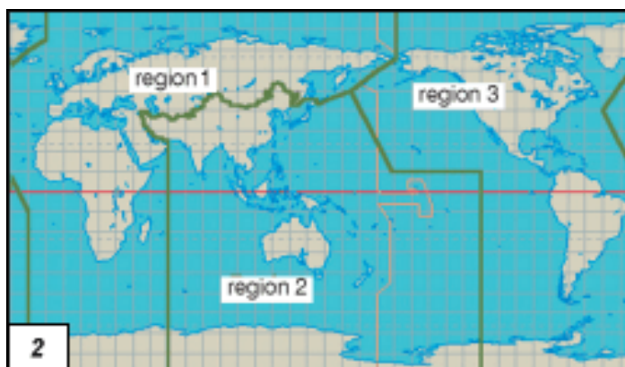
Obr. 3: Světové regiony se stejnými nebo velmi podobnými frekvencemi pro RFID v pásmu UHF
