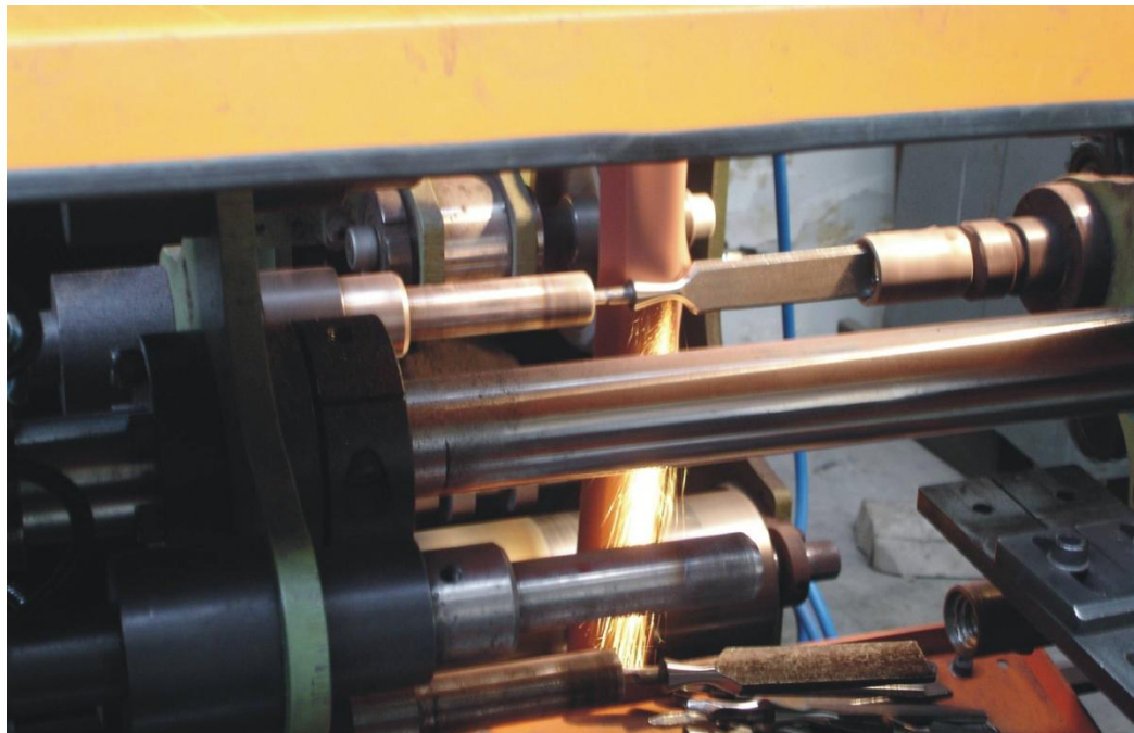
OBRÁZEK 18: DETAIL BROUŠENÍ KRČKU
