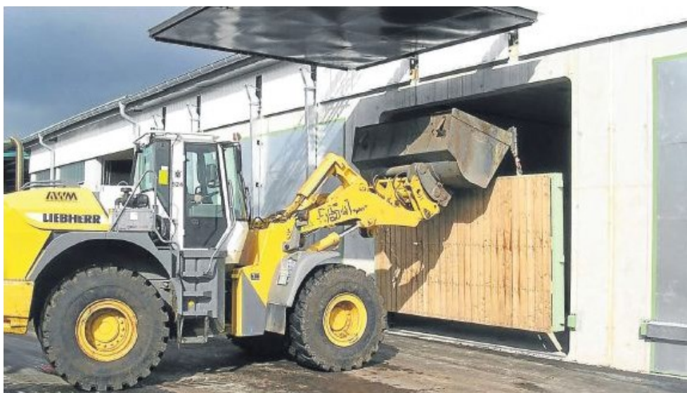
Obrázek 5: Plnění reaktoru bioplynové stanice na bázi suché fermentace
