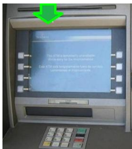
Obrázek 18: Skimovací zařízení se snímací kamerou
