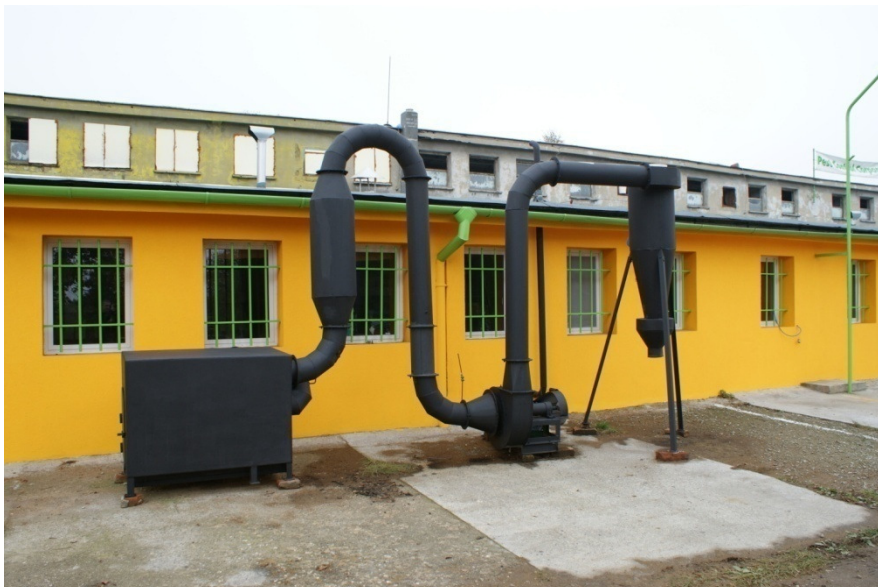
Obrázek 10: Sušička na piliny
