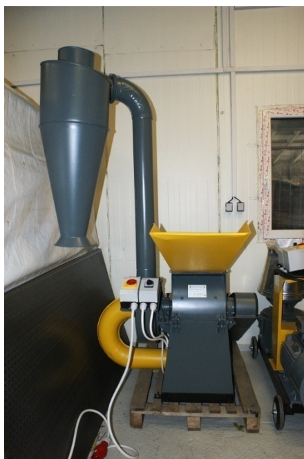
Obrázek 8: Kladívkový drtič na biomasu
