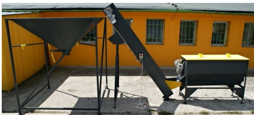
Obrázek 11: Chladička pelet s dopravníkem do plničky big bagů
