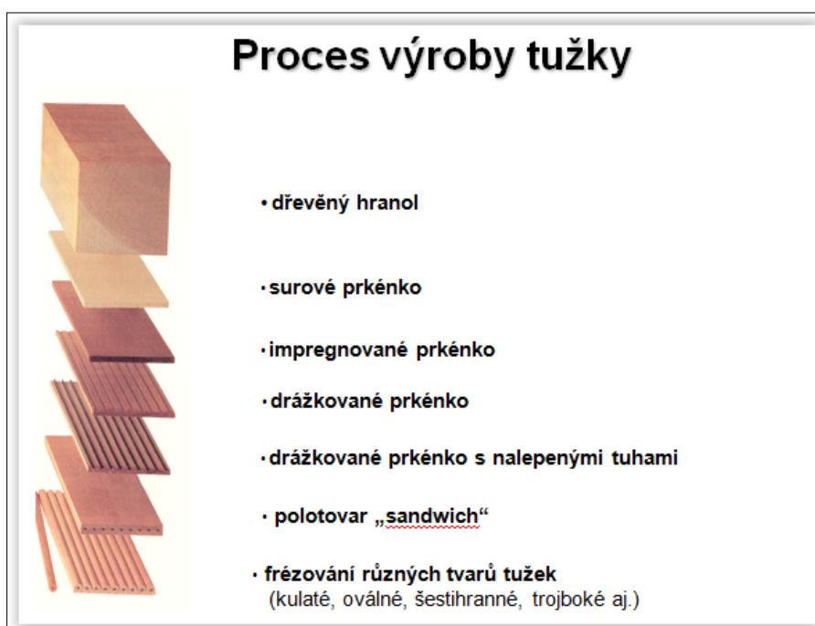
Obrázek 4: Proces výroby dřevěné tužky
