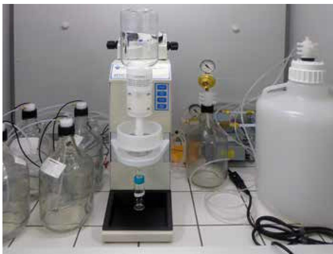
Obr. 1. Automatické extrakční zařízení pro extrakci na pevné fázi SPE-DEX 4790 (Horizon Technology)
