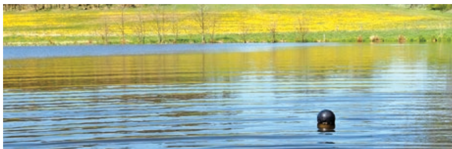
Buchamer u Blatné IV - plovák sondy pro měření a záznam teploty
