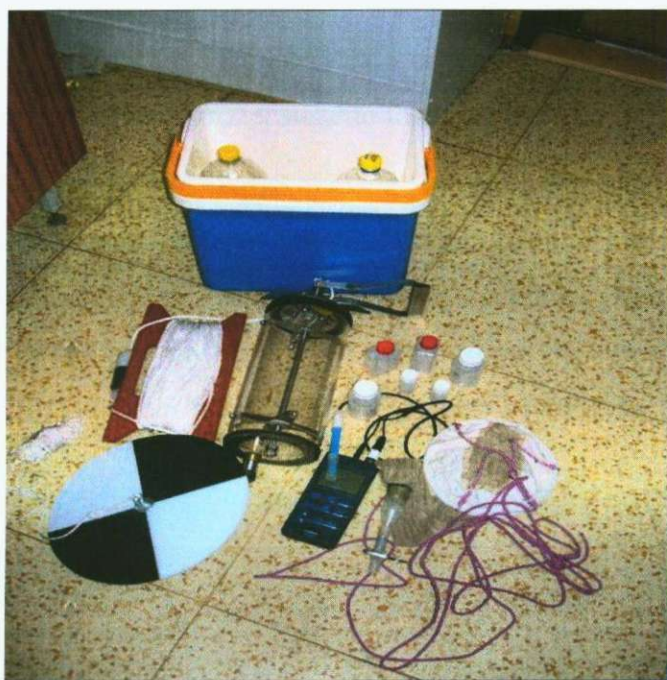
Obrázek 1: Pomůcky používané v terénu: chladicí taška, PET lahvičky, planktonní síť, pH-metr se sondou na měření pH, teploty a \text{O}_2 , Secchi disk, Friedingerovo odběrné zařízení.
