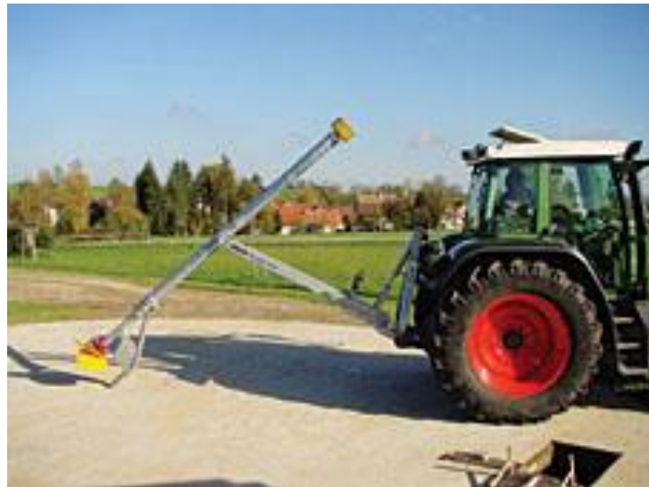
Obr. 6 Vrtulové míchadlo firmy RECK
