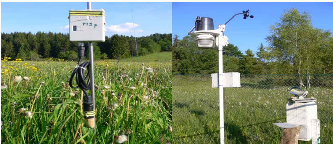
Obr.10. – Datalogger pro měření teplot a vlhkostí firmy Comet (vlevo) a automatická meteorologická stanice Vantage Pro (Davis Instruments – USA).
