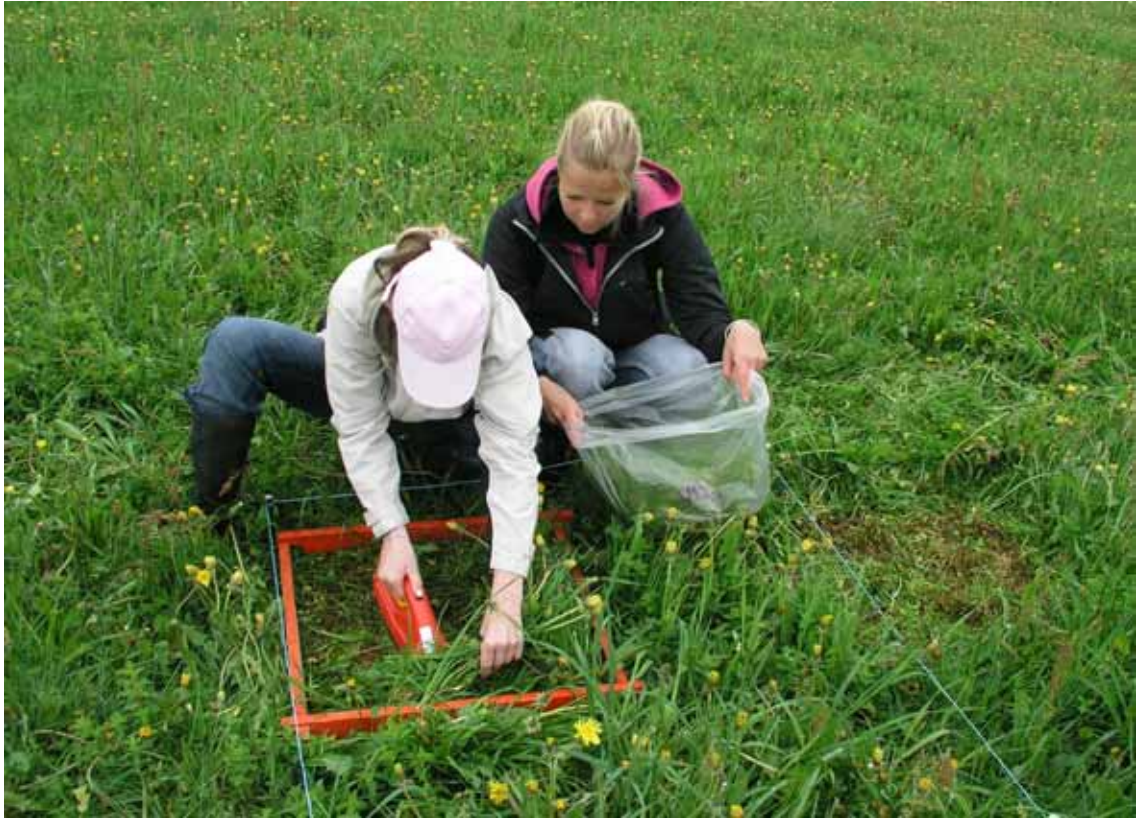
Obr.11: Odběr biomasy pomocí speciálních elektrických nůžek.
