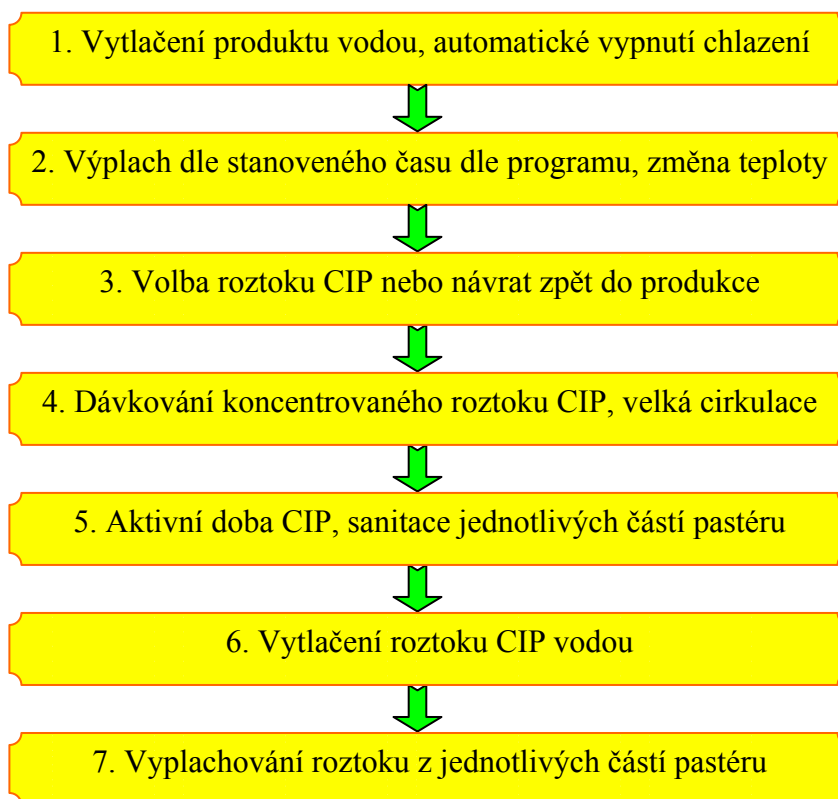
Obrázek 4 : Diagram principu fungování CIP
