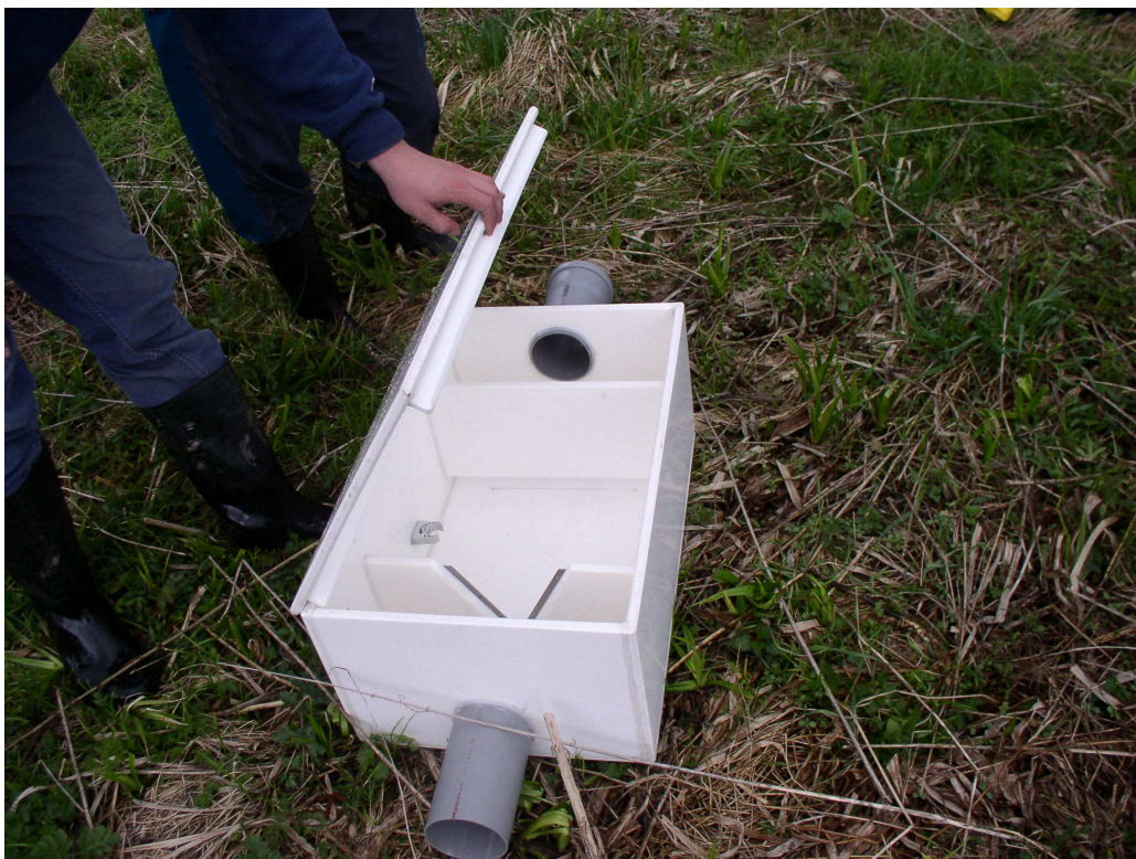
Obr. 2 : Měrný box před instalací
