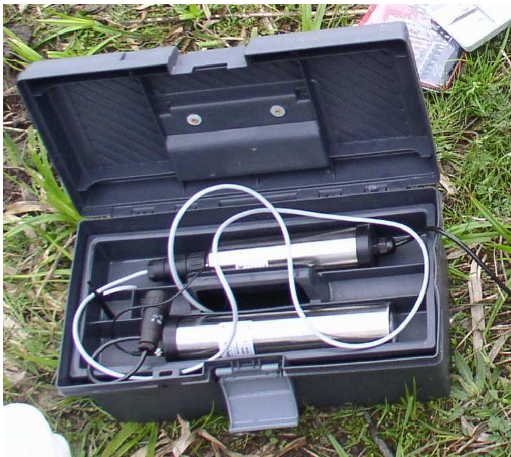
Obr. 4: Telemetrická sestava - datalogger + komunikační modul
