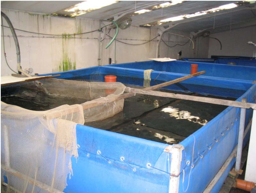
Obr. C1: Průtočné gumotextilní nádrže.
