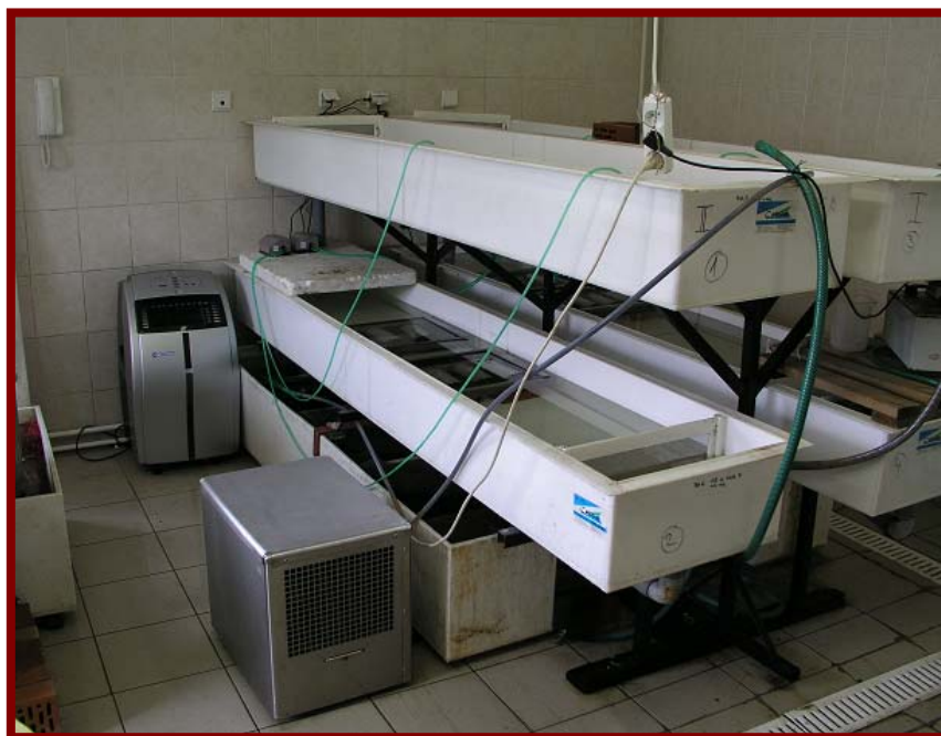
Obr. 15: Odchovný recirkulační systém.
