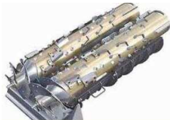
Obr. II – 4. Dva podélné rotory New Holland CR.
