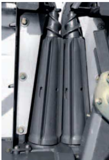
Obr. II – 15. Kónické trhací válce adaptéru Claas Conspeed.
