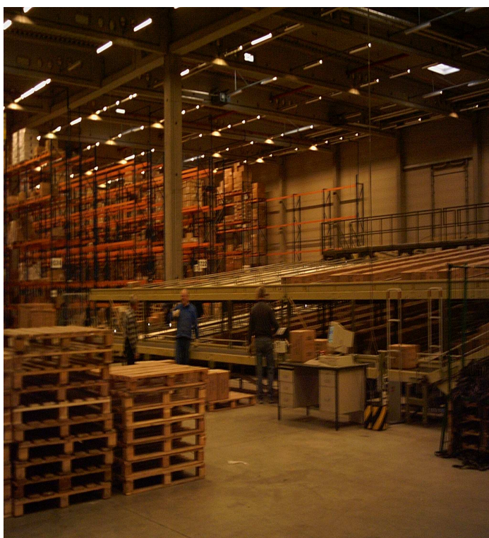
Obr.: 11 Regálový systém v distribučním centru a rozřid'ovací linka
