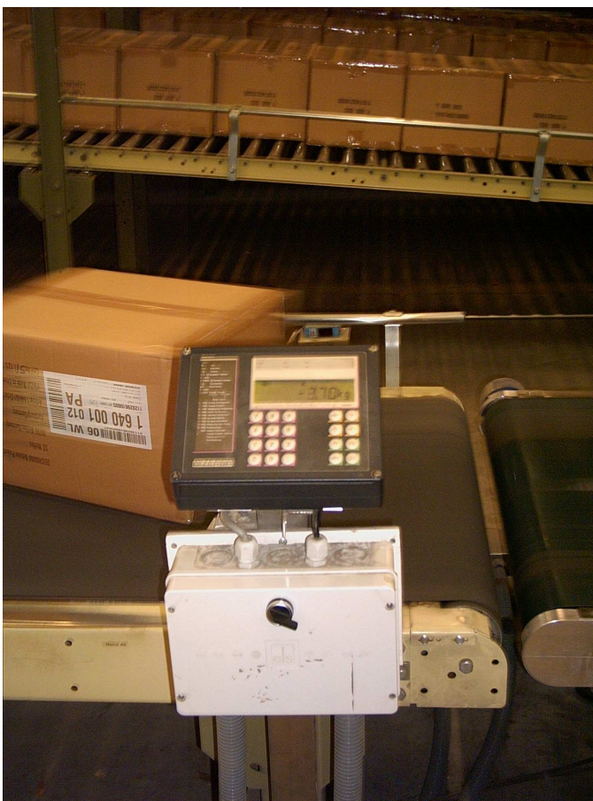
Obr.: 9 Kontrolní váha na rozříd'ovacím pásu
