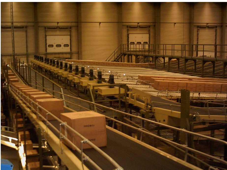
Obr.: 7 Roztříd'ovací pásy v distribučním centru
